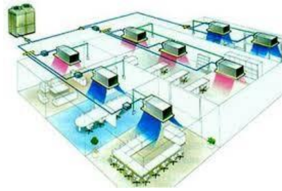
Şekil 2.27 Hava soğutmalı dış üniteli ısı geri kazanımlı VRV/VRF sistemler.
