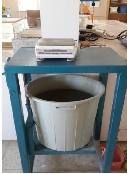
Resim 3.7 Arşimet prensibi ile çalışan tartı.
