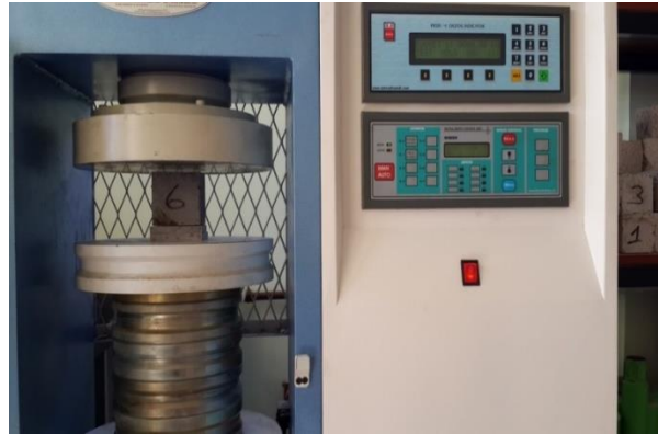
Resim 3.5 Deney örneklerinin basınç dayanımlarının belirlenmesi.
