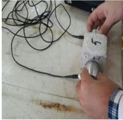
Resim 3.4 Deney örneklerinin ultrases geçiş hızlarının belirlenmesi.
