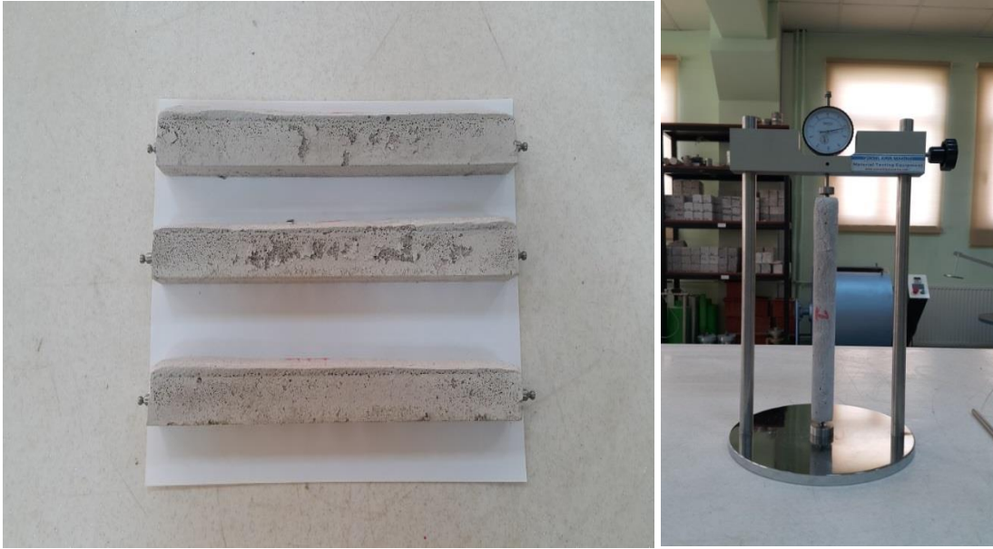
Resim 4.4 Rötire ölçüm çubukları ve komparatör.
