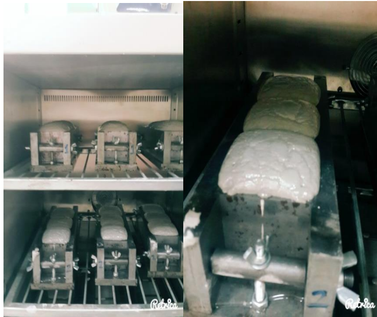
Resim 3.2 Deney örneklerinin kür işlemi öncesi sertleştirilmesi.
