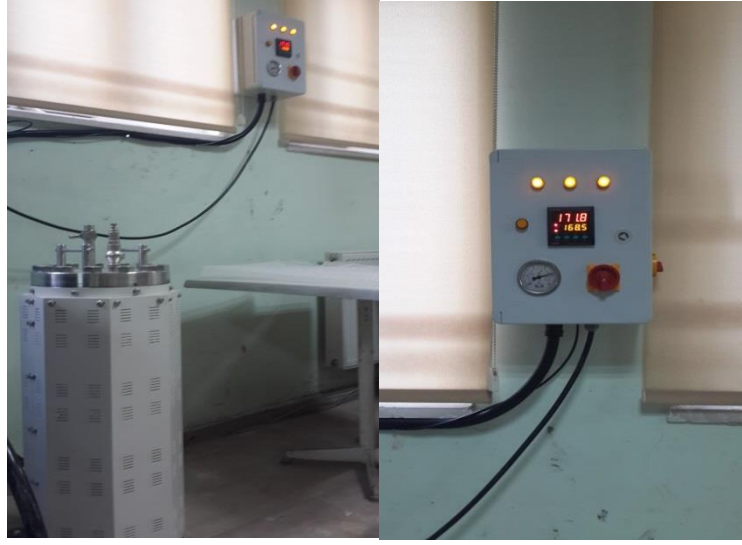
Resim 3.3 Deney örneklerinin otoklav içerisinde kür edilmesi.
