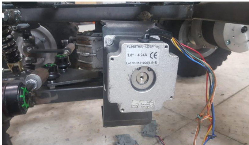
Şekil 4.31 Yönlendirme sistemi imalatı ve montajı.
