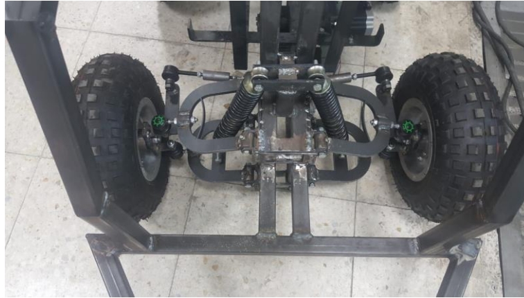
Şekil 4.27 Ön süspansiyon sistem imalatı ve montajı.
