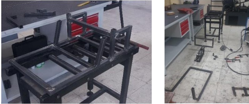
Şekil 4.25 KA şasi parçalarının birleştirilmesi.
