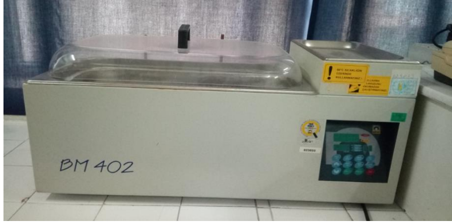
Resim 3.3 Termometrelerin doğrulamalarının yapıldığı benmari cihazı.
