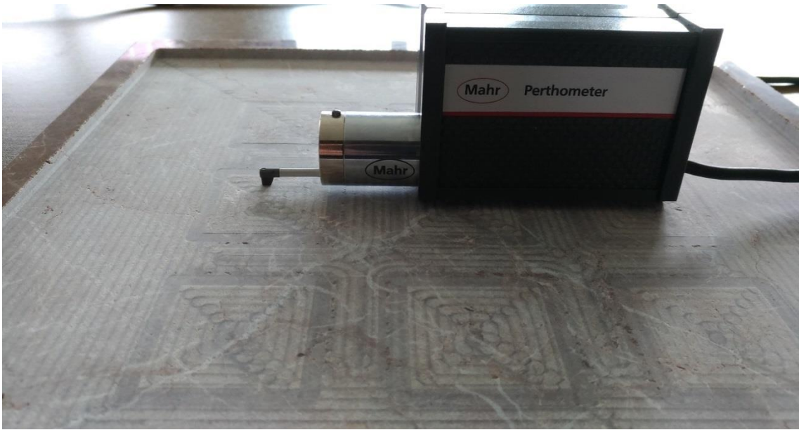
Resim 3.22 Örnek yüzey pürüzlülük ölçümü.
