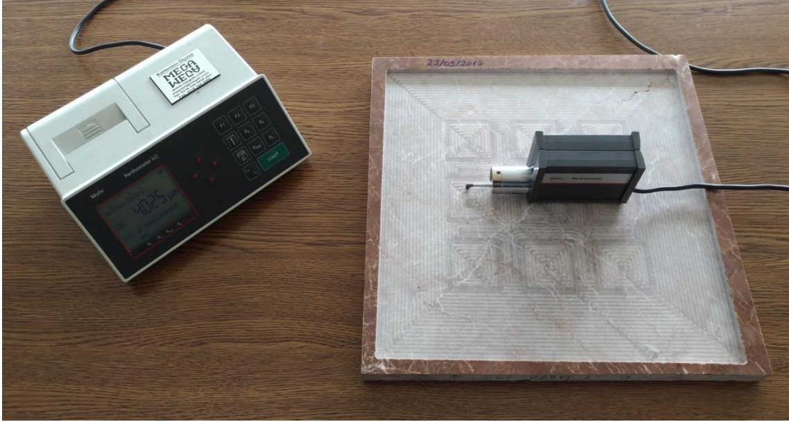
Resim 2.2 Mahr Perthometer M2 model yüzey pürüzlülük ölçüm cihazı.
