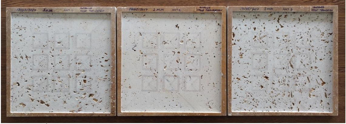
Resim 3.18 İşlenmiş Antalya Noçe Traverten numuneleri.
