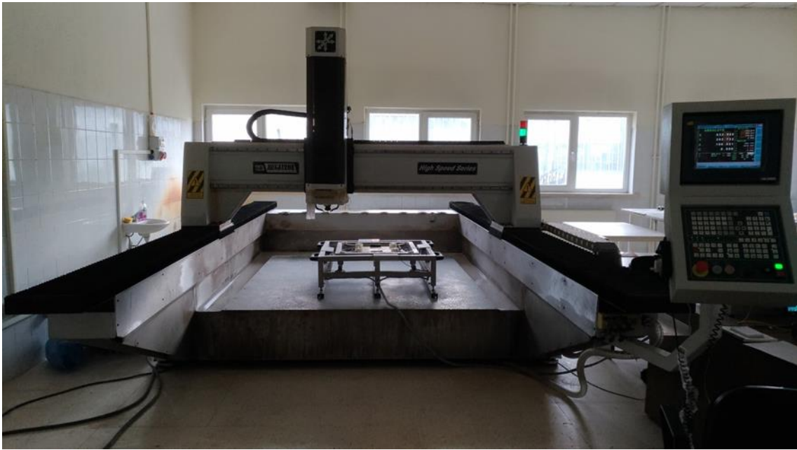
Resim 3.1 Megatron marka CNC doğal taş işleme makinesi.
