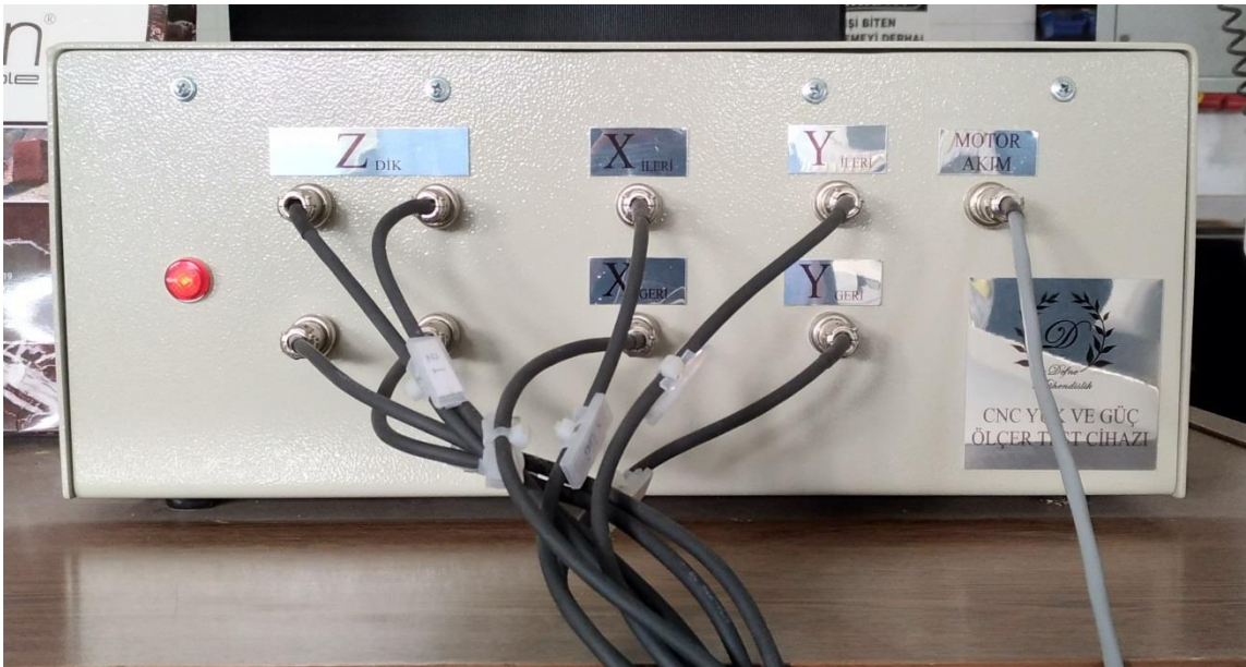
Resim 3.6 Yük ve güçleri ölçen veri toplama cihazı.
