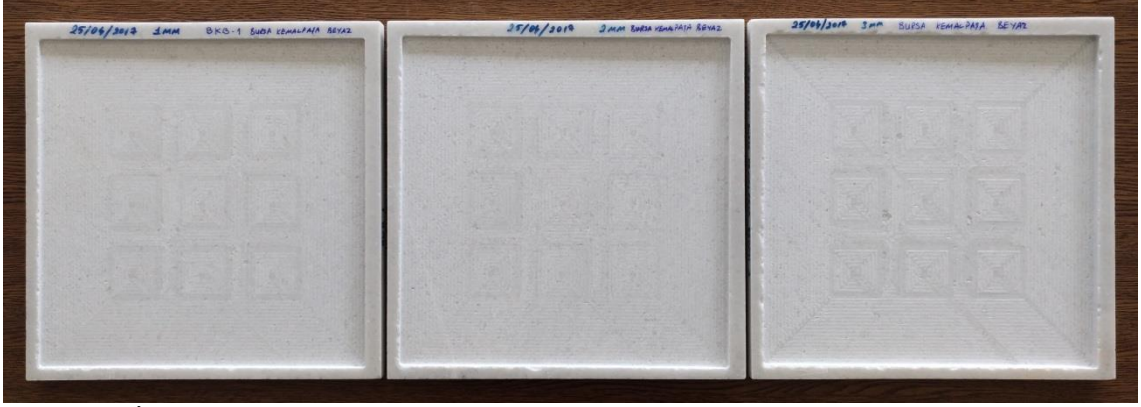
Resim 3.9 İşlenmiş Bursa Kemalpaşa Beyaz numuneleri.
