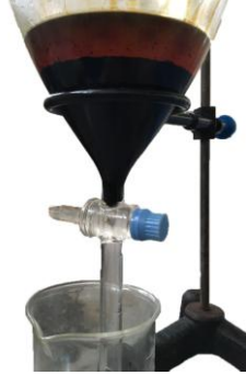
Resim 3.11 Ayırma hunisinde pirolitik yakıt ve suyu ayırma işlemi.
