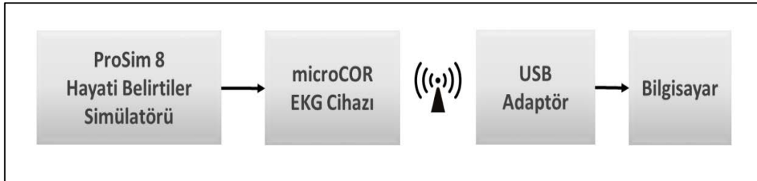
Şekil 3.11 Mİ erken tanı ve lokalizasyon tespit sisteminin blok diyagramı.
