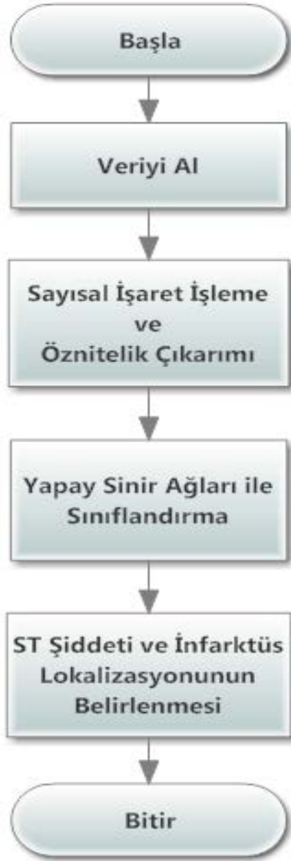
Şekil 3.12 Mİ erken tanı ve lokalizasyon tespit sisteminin yazılım algoritması.
