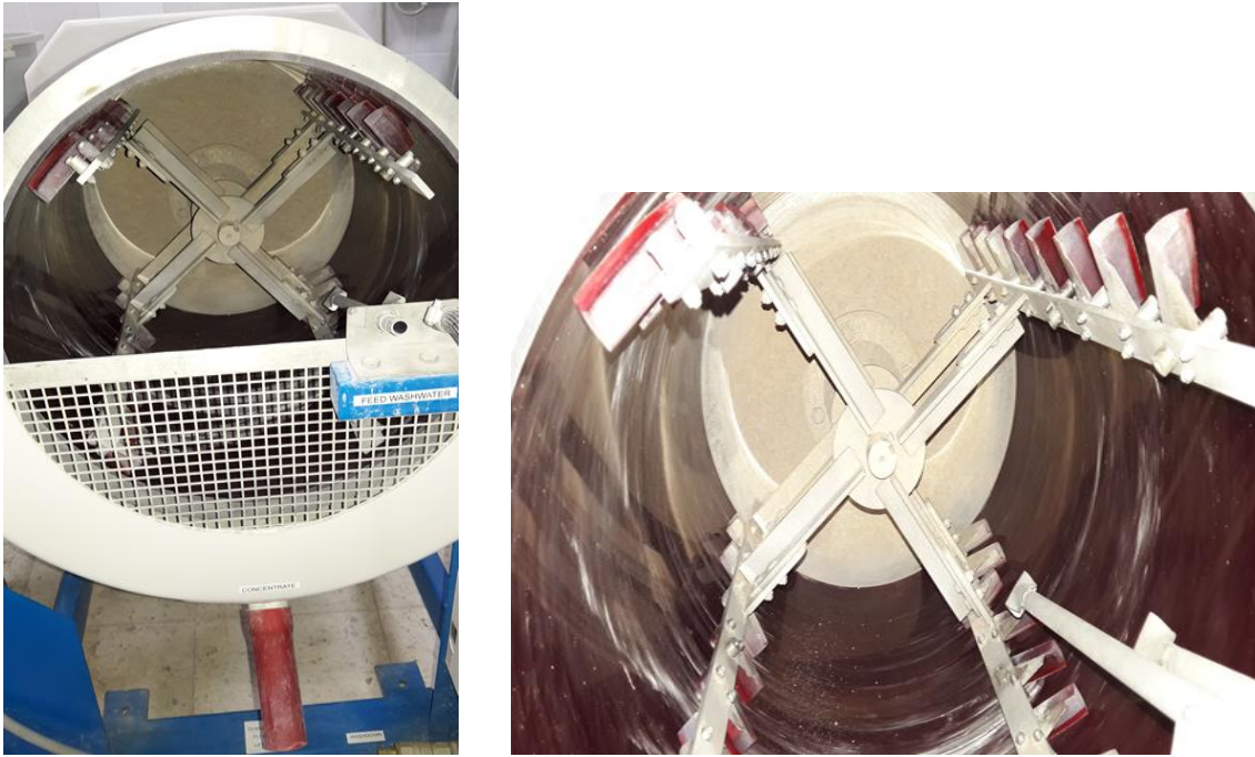
Resim 4.3 MGS yoğun malzeme çıkış kısmı ve iç dizaynındaki küreyiciler.
