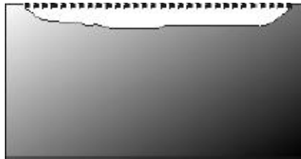
Şekil 2.20 Homojen dağılımlı korozyon (Görener 2007).
