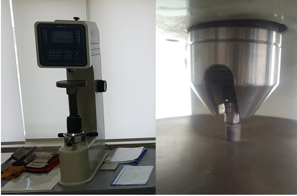
Resim 3.4 Sertlik ölçme cihazı ve Rockwell-C Adhezyon testinin uygulanması.
