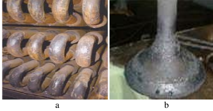
Resim 2.1 a) Isı deęiřtiricide atmosferik kořullarda yüksek sıcaklık korozyonu, b) Vanadyum ile yüksek sıcaklık korozyonuna uęramıř egzoz valfi. (MEB 2007).
