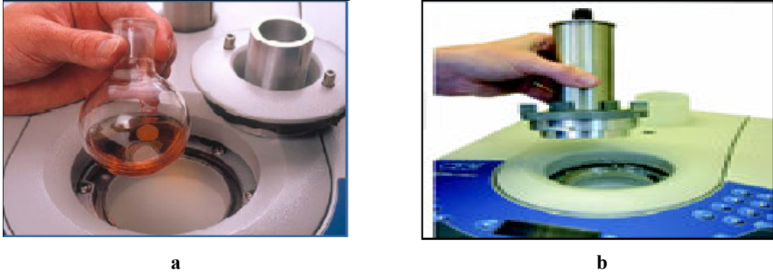
Şekil 2.15 a) Atmosferik şartlar için tasarlanmış ve yüksek basınç ve kapalı sistemler için sentez amaçlı üretilen bir tekli-mod mikrodalga cihazları
