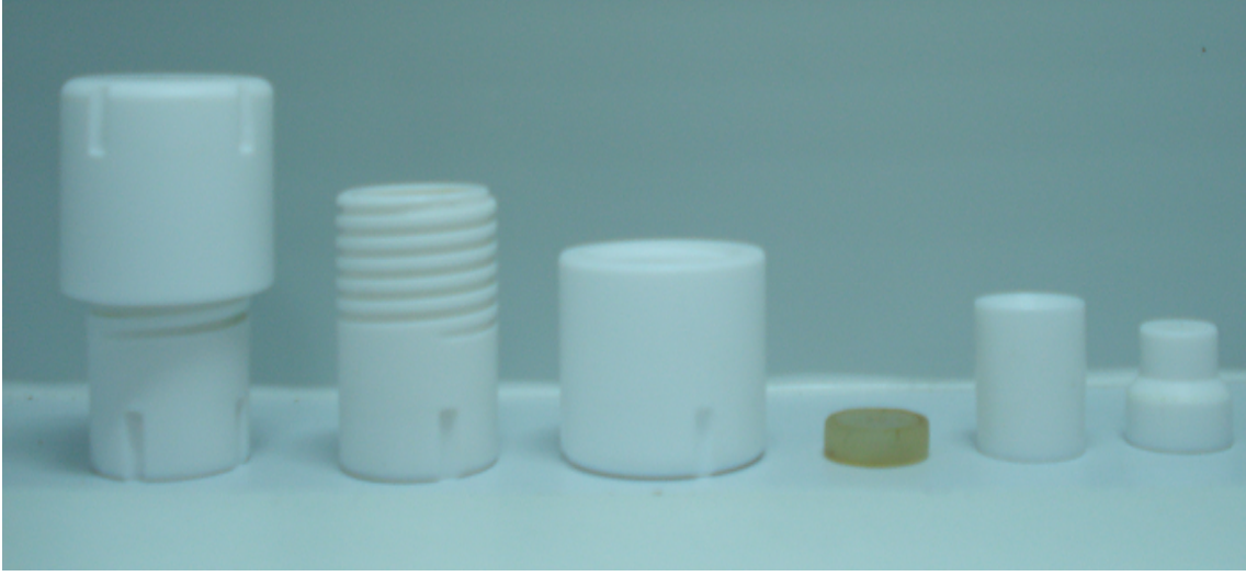
Resim 3.1 Özel tasarım mikrodalga reaksiyon kabının parçaları.
