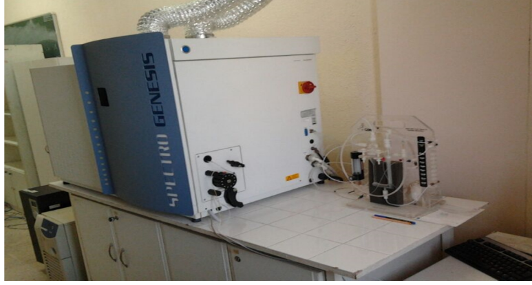
Resim 3.4 Spectro Genesis Fee model indüktif eşleşmiş plazma optik emisyon spektrometresi
