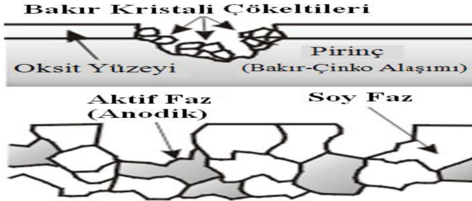
Şekil 2.7 Seçimli korozyonun şematik gösterimi (Palta 2009).
