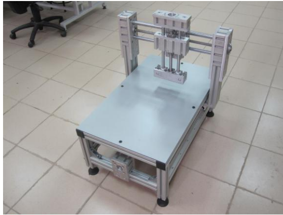
Şekil 2.16 3 eksenli masaüstü CNC router tasarımı (Uyanık ve arkadaşları 2011)
