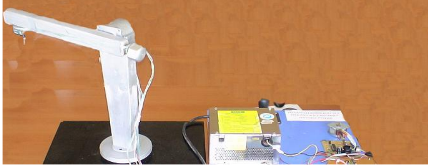
Şekil 2.17 Tasarlanan robot kol ve kontrol paneli (Yılmaz 2007)
