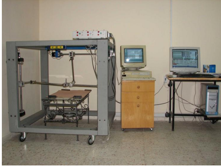
Şekil 2.18 Kartezyen robot tasarımı
