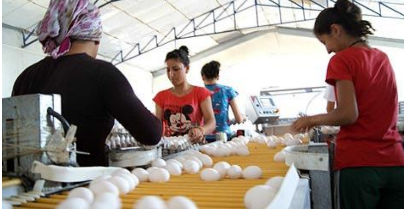
Resim 2.15 Kusurlu yumurtaların insan gücüyle besleme bandından ayrıştırılması.
