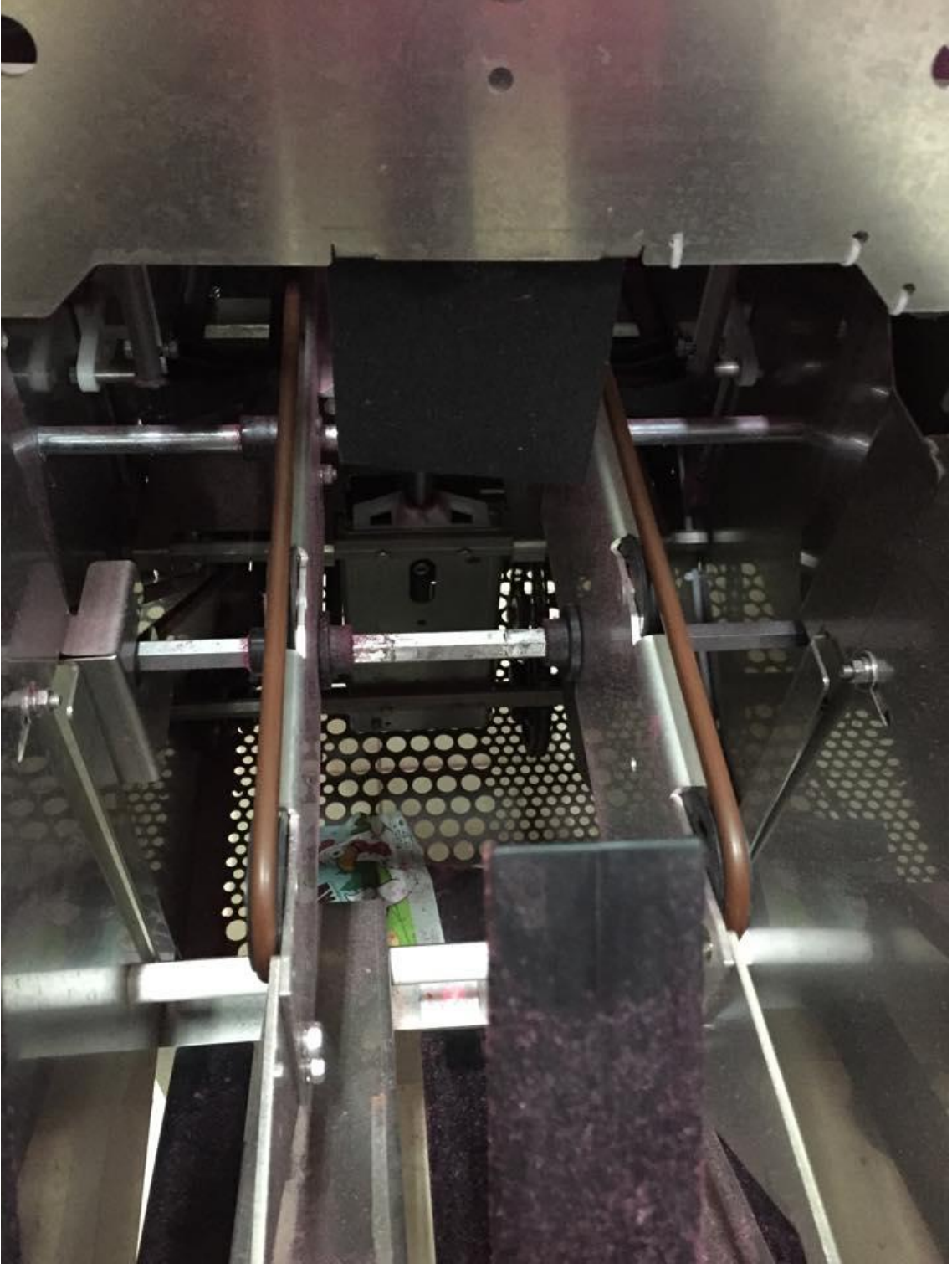
EK 6. Farklı tip viyolleri ayıran otomatik viyol makinesinin iç görünüşü.
