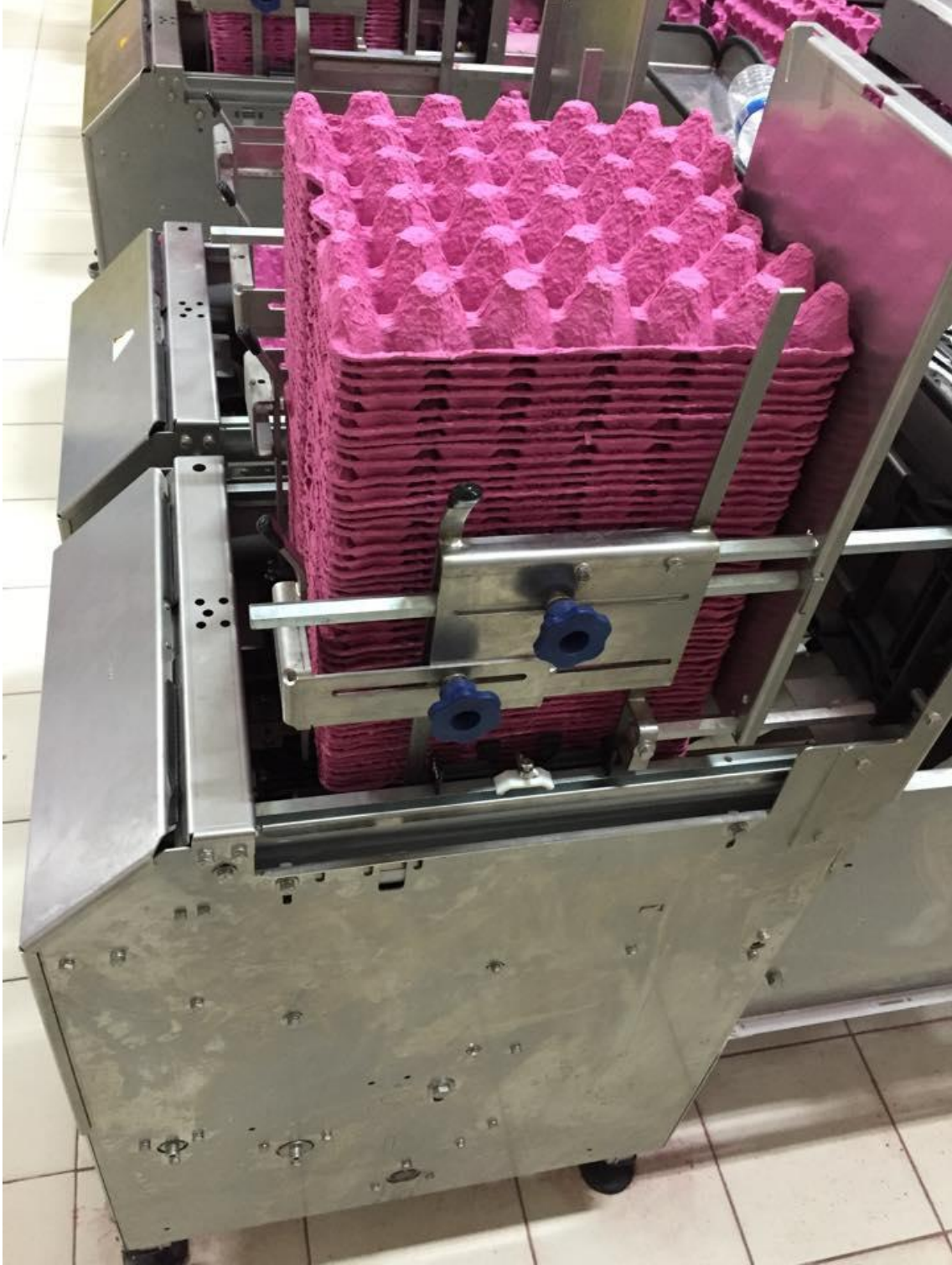
EK 5. Farklı tip viyolleri ayıran otomatik viyol makinesinin yandan görünüşü
