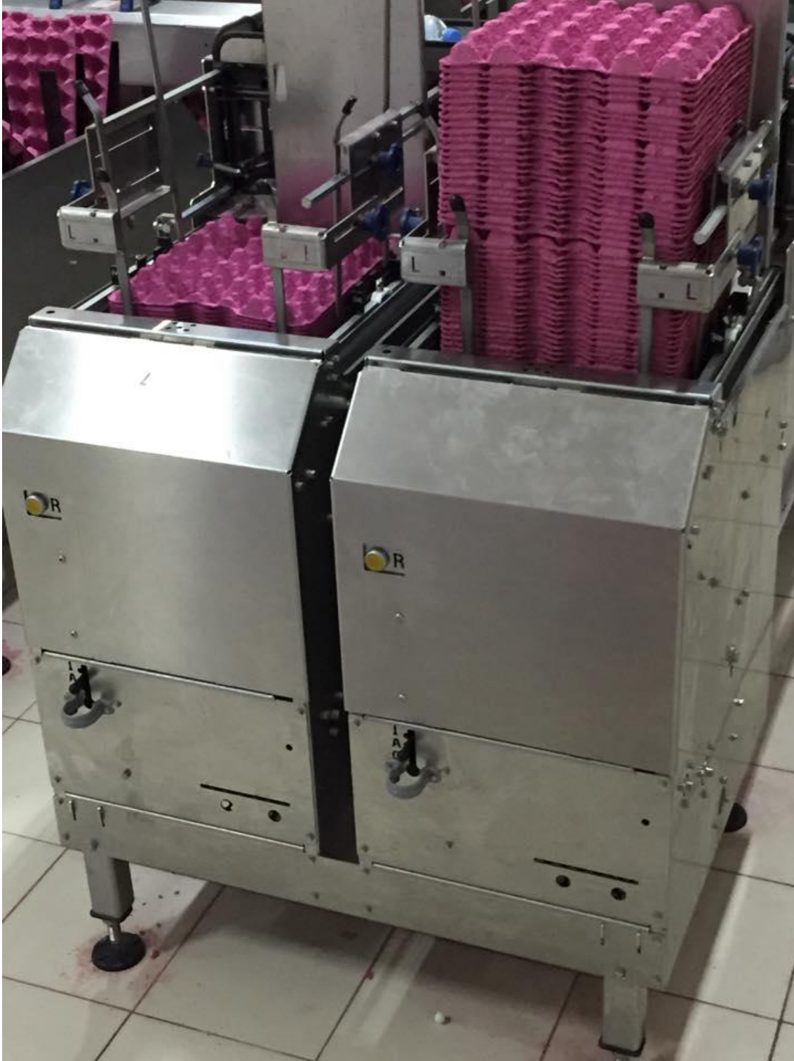
EK 4. Farklı tip viyolleri ayıran otomatik viyol makinesinin önden görünüşü
