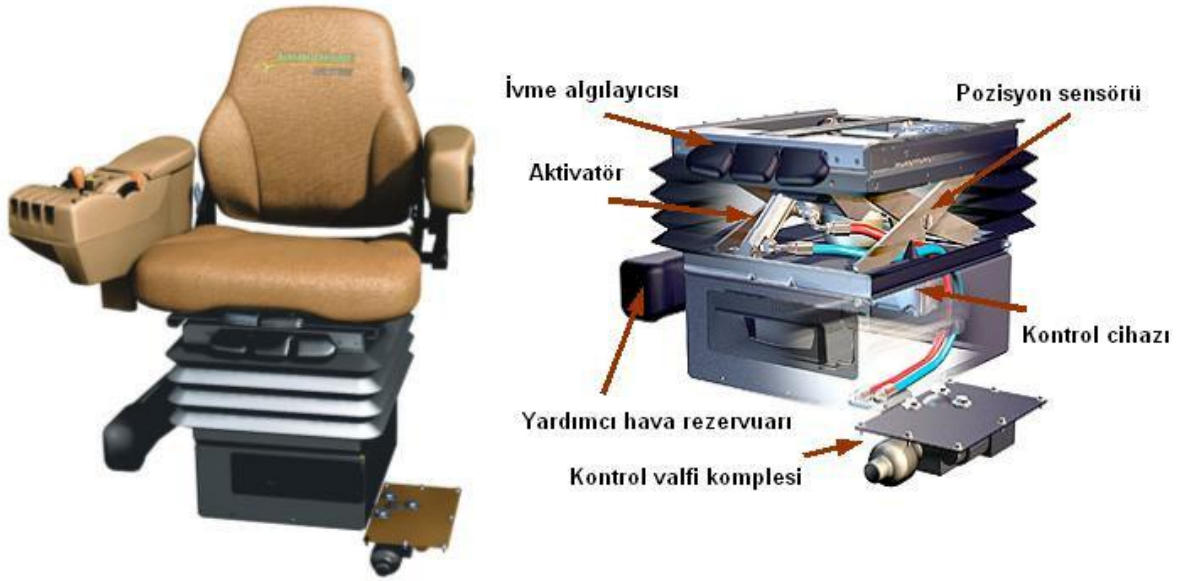
Şekil 2.2 Aktif süspansiyonlu John Deere Active Seat şeması (Dufner and Schick 2002)
