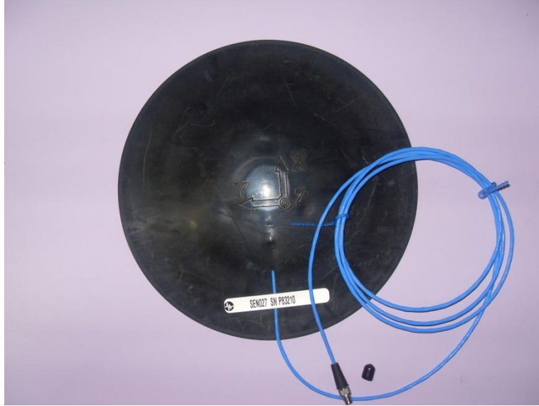
Şekil 3. 3 Oturak ped ivmeölçer
