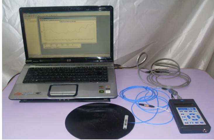
Şekil 3. 1 HVM100 cihazı bağlantısı
