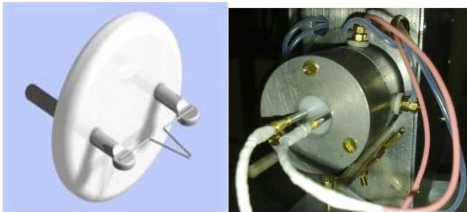
Şekil 3.6 Hairpintipi filament ve filamentin elektron tabancasına yerleştirilmiş halinin görüntüsü.
