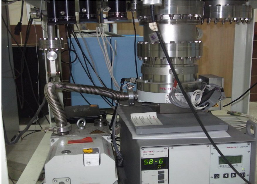
Şekil 3.2 Turbo moleküler ve mekanik pompalar, basınç ölçüm-görüntüleme cihazları ve bağlantılarının birlikte bulunduğu istasyonun yakından görünümü.
