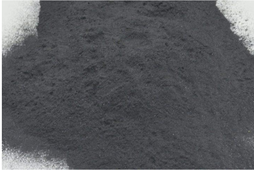
Şekil 2.3 Proses Sonucu Oluşan B 4 C.
