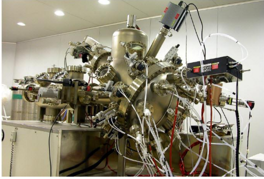
Şekil 2.8 Moleküler Demetli Epitaksi (MBE).
