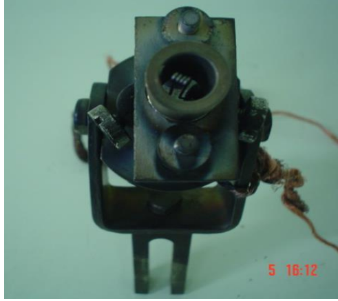
Şekil 3.4 Doğrudan ısıtmalı katodun fotoğrafı.
