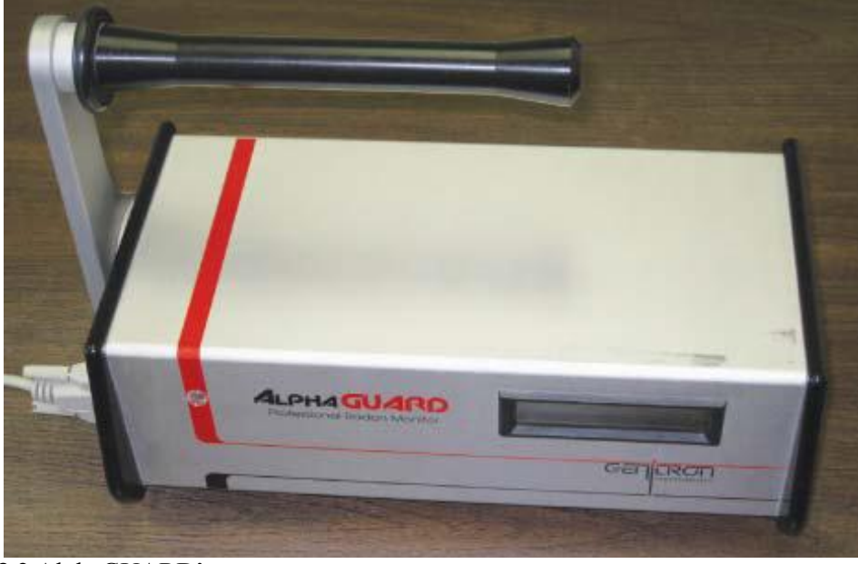
Resim 3.2 AlphaGUARD'ın üstten görünümü.
