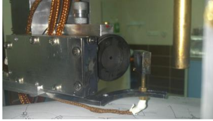
Şekil 3.8 Faraday Elektron toplayıcısına üzerine yerleştirilen küçük boyuttaki FET' in fotoğrafı.
