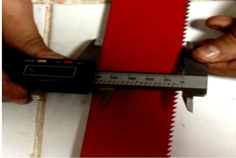
Şekil 4.8 Digital kumpas ile diş kırılmalarının ölçülmesi.
