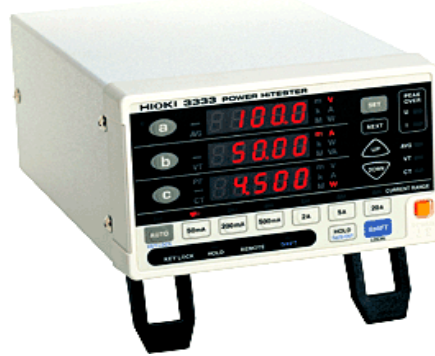
Şekil 4.7 Kesme deneylerinde kullanılan enerji analizörü (Eken 2013).
