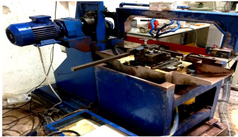
Şekil 4.3 Deneylerde kullanılan bilgisayar kontrollü kesme makinesi.
