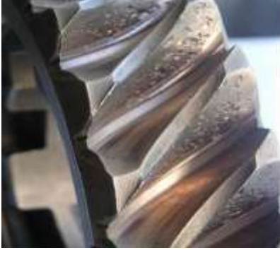
Şekil 2.3 Yorulma ve Delaminasyon aşınmanın temel mekanizması.
