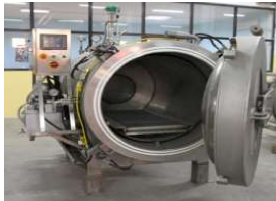
Resim 2.1 Kriyojenik işlemin yapıldığı azot tankı görünümü (Alper Isıl İşlem San. ve Tic. A.Ş 2012 ).
