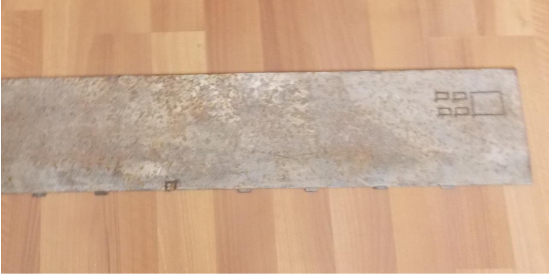
Resim 4.4 Lama ve soket üzerinden kestirilen numuneler.
