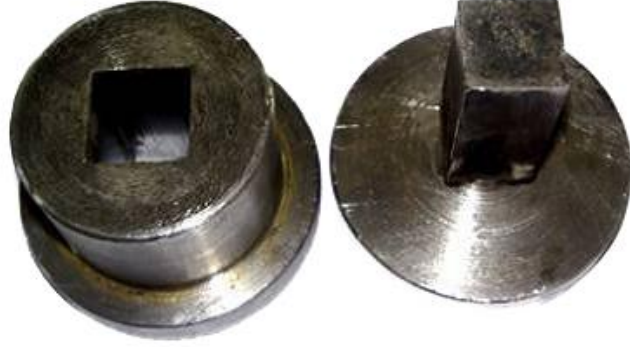
Resim 3.26 Deney numunelerinin üretildiği soğuk presleme kalıbının görünüşü.
