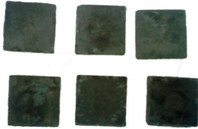
Resim 3.29 Sıcak pres ile imal edilen balata resimleri.
