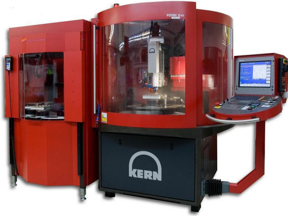
Şekil 2. 4 Mikro frezeleme için üretilmiş özel tezgâh.
