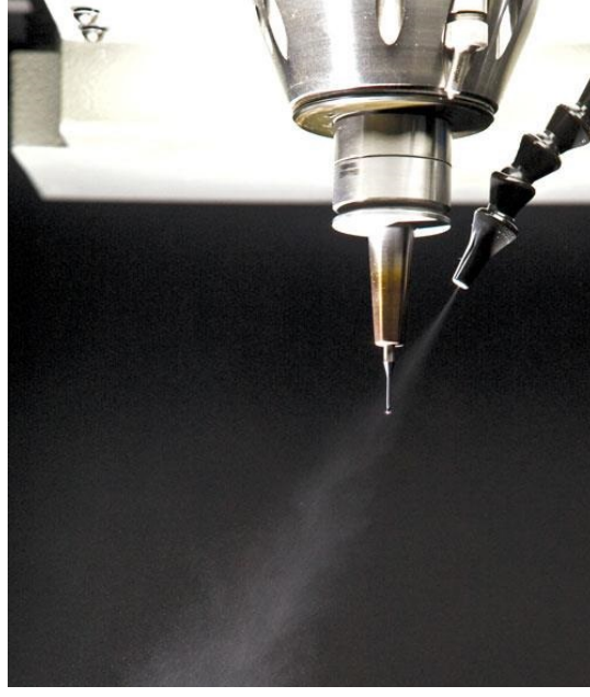
Şekil 2. 15 Mikro frezeleme işleminde MQL uygulaması.
