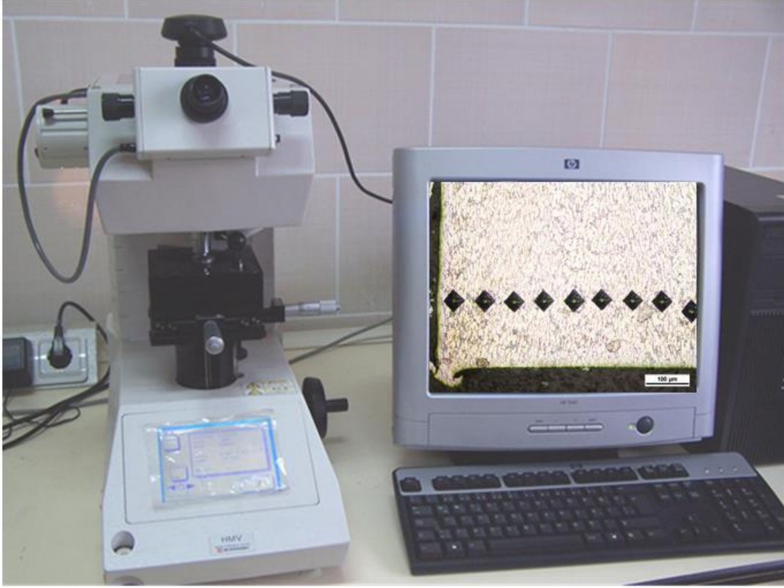
Şekil 3. 14 Mikro sertlik ölçümü için kullanılan cihaz.
