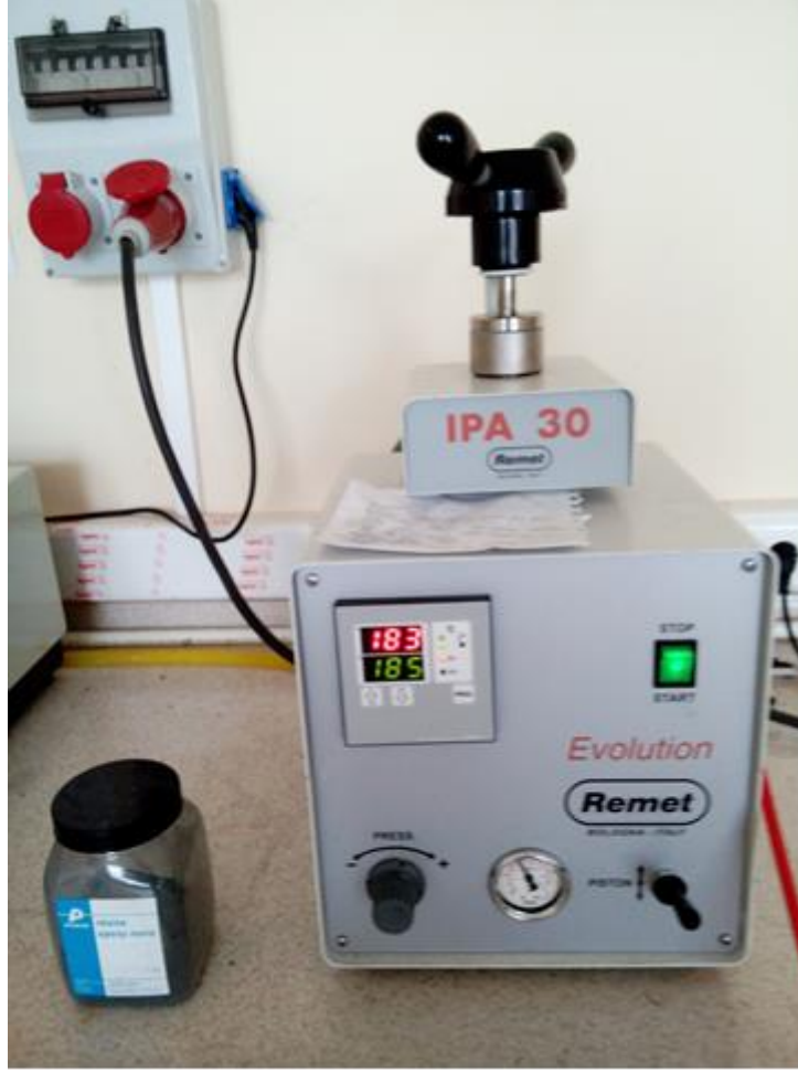
Şekil 3. 11 Numuneleri bakalit kalıba almak için kullanılan bakalitleme cihazı.
