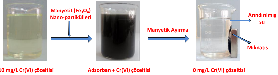
Şekil 4.7 Manyetit nano-tanecikler (Fe 3 O 4 ) ile sulu ortamlardan Cr(VI) adsorpsiyonu
