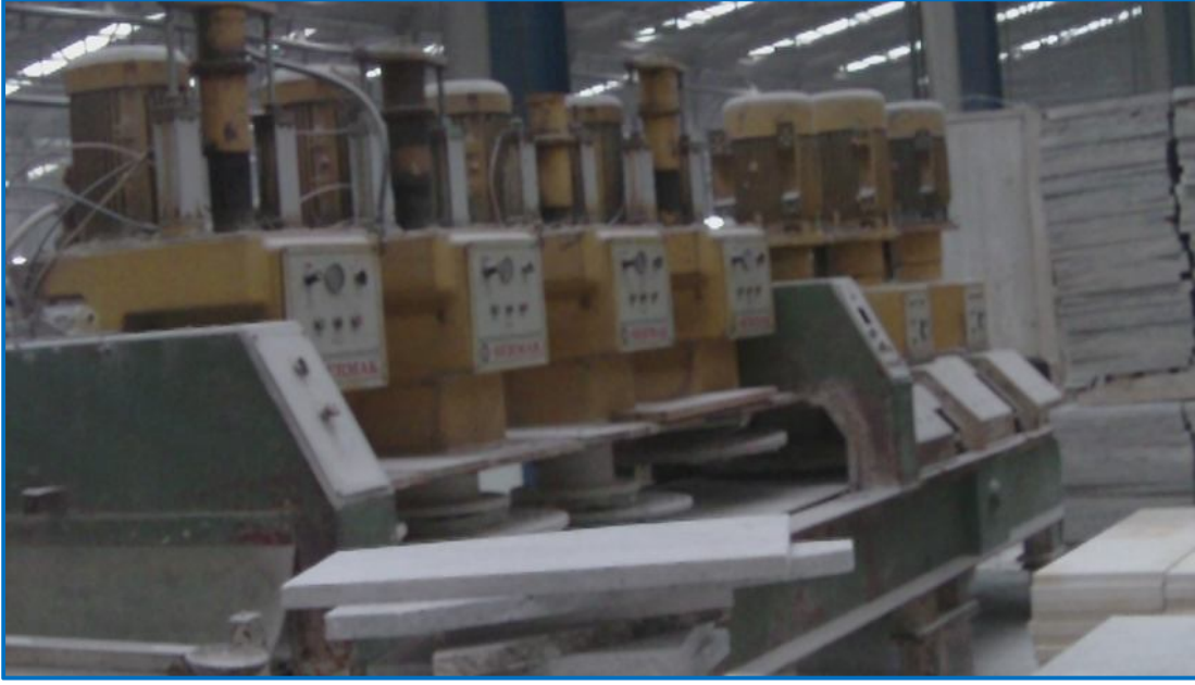
Resim 2.14 Sarioğulları marka fayans hattı 3+4 kafa. (Kara Mehmet Mermer Ltd. Şti).
