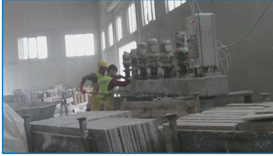
Resim 2.9 Traverten dolgu makinası. (Kara Mehmet Mermer Ltd. Şti).
