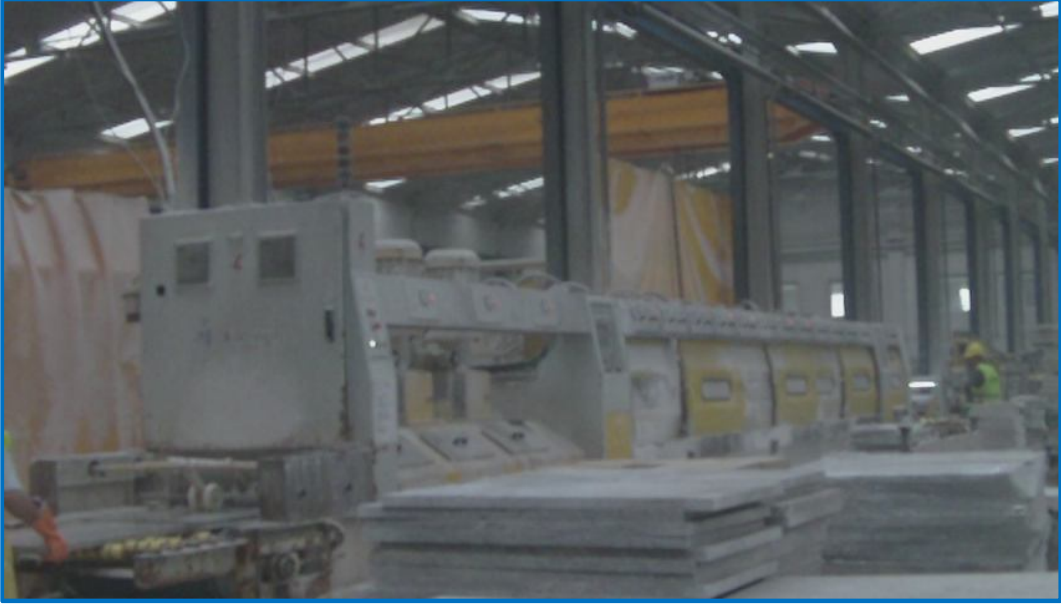
Resim 2.12 Toksel marka fayans hattı 10+4 kafa. (Kara Mehmet Mermer Ltd. Şti).
