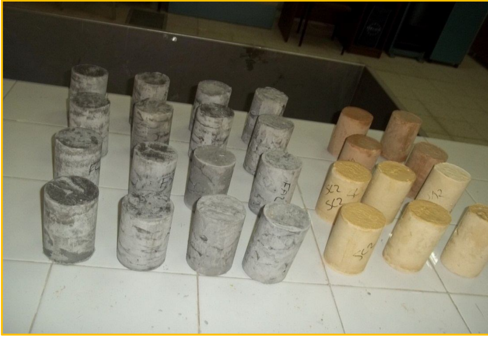
Resim 3.2 Kalıptan çıkarılmış döküm numunesi.
