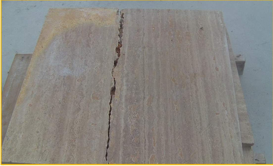
Resim 4.1 D tane boyutundaki dolgu uygulamada pütürtü bir görünüm.
