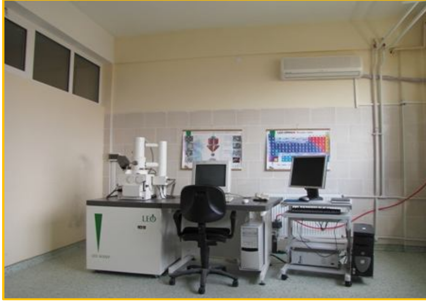
Resim 3.6 Taramalı elektron mikroskobu ( Leo-1430 VP).
