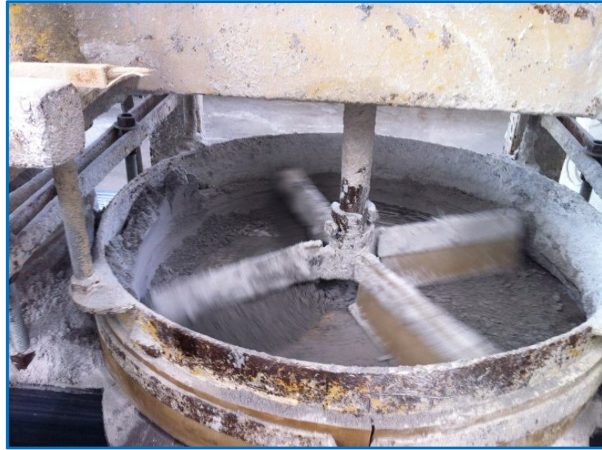
Resim 2.10 Traverten dolgu makinası çemberi. (Kara Mehmet Mermer Ltd. Şti).
