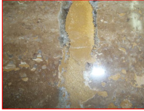
Resim 4.7 Noche traverten kür aşamasındaki gözenek görüntüsü.
