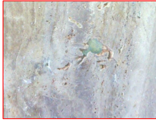
Resim 4.8 Noche traverten gözenek yapısı.
