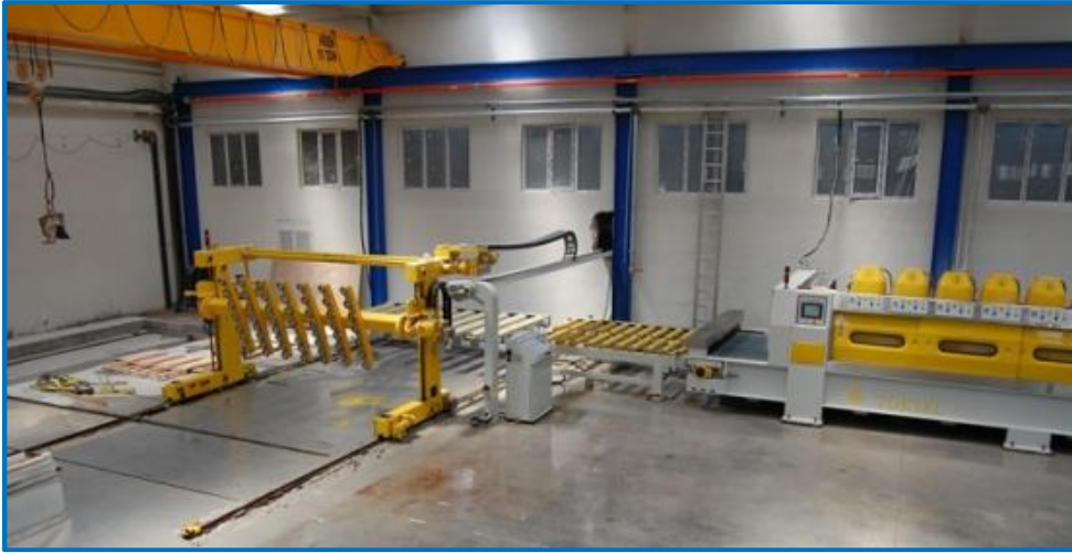
Resim 2.11 Toksel marka levha hattı 13+3 kafa. (Kara Mehmet Mermer Ltd. Şti).
