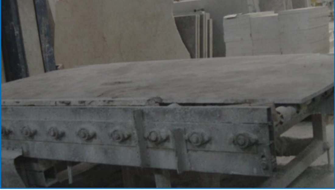
Resim 3.4 Tesis levha hattı dolgu yöntemi. (Kara Mehmet Mermer Ltd. Şti).
