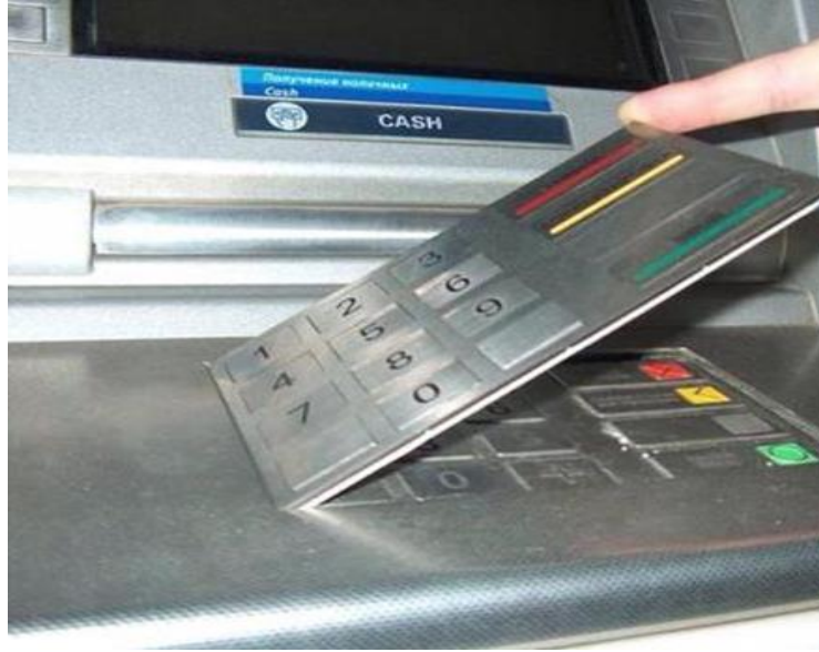
Resim 5.19 ATM üzerine takılı pin pad (tuş takımı) (İnt. Kyn. 50).
