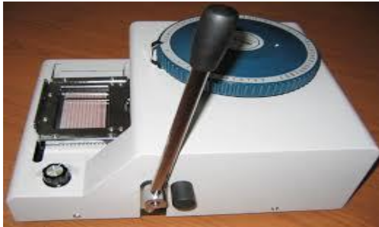
Resim 5.23 Embosser (Kabartma baskı) cihazı (İnt. Kyn. 56).
