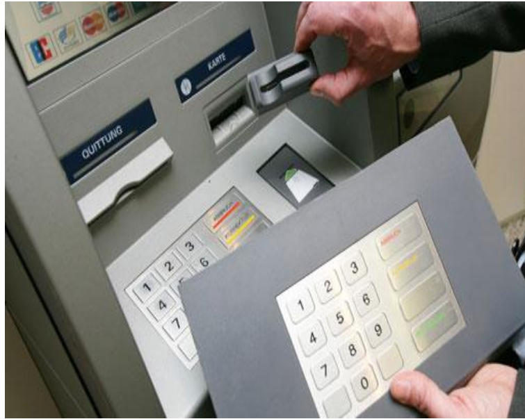
Resim 5.18 ATM üzerine takılı pin pad (tuş takımı) (İnt. Kyn. 49).
