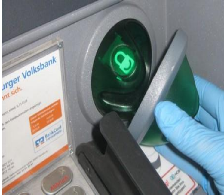
Resim 5.16 ATM üzerine takılı kart kopyalama cihazı (İnt. Kyn. 47).
