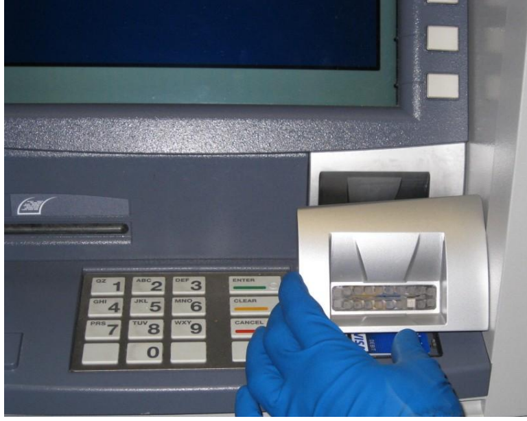
Resim 5.17 ATM üzerine takılı kart kopyalama cihazı (İnt. Kyn. 48).
