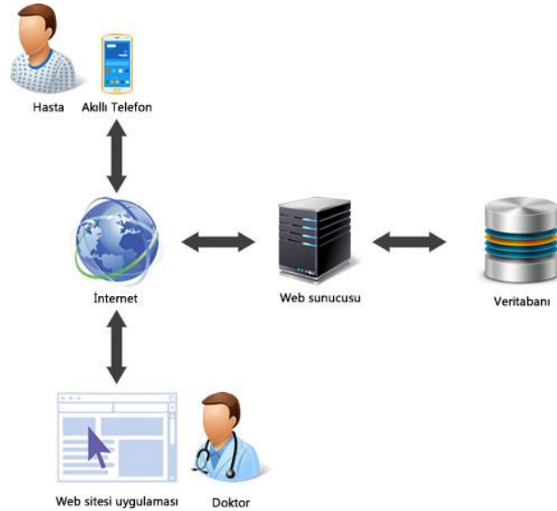
Şekil 4.1 Mobil hasta takip sistemi ve değerlendirme sistemi mimarisi.
