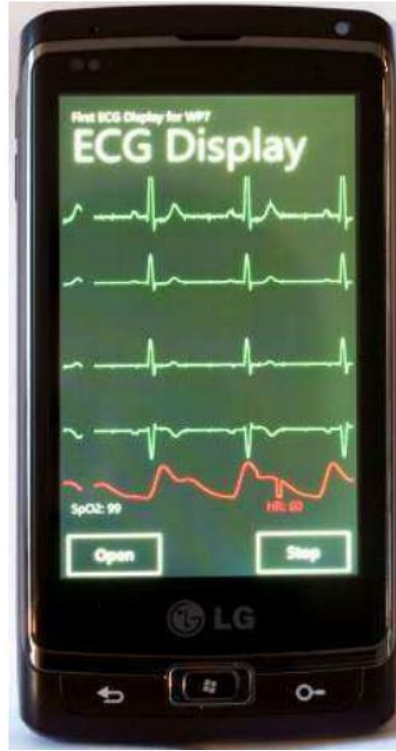
Resim 2.20 Uygulamanın gerçek Windows Phone 7 üzerinde görüntüsü. 3.5'' dokunmatik ve 480 x 800 piksel çözünürlüklü ekran (Klug et al. 2010).
