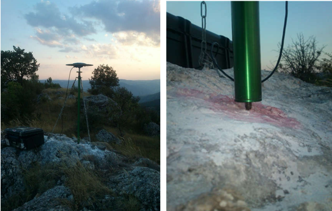
Resim 4.3 23.08.2014 tarihli yer noktası üzerinde zincirli tripod ile GNSS ölçmesi.
