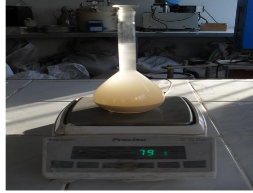
Şekil 3.11 Filler malzemesi ve malzemenin piknometre içerisindeki durumu.
