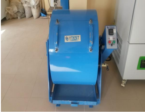
Şekil 3.12 Los Angeles aşınma cihazı ve deneye tabi tutulmuş numune.
