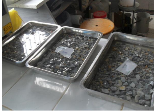
Şekil 3.10 Agreganın numunesinin su içerisinde bekletilmesi.
