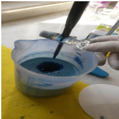
Şekil 3.7 Numuneye metilen mavisi eklenmesi ve karıştırılması.
