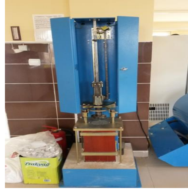
Şekil 3.20 Çalışmada marshall deney numunelerini sıkıştırmak için kullanılan otomatik tokmak.
