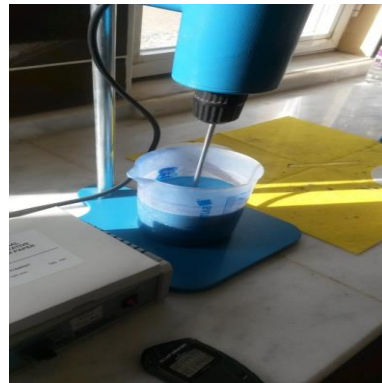
Şekil 3.7 Numuneye metilen mavisi eklenmesi ve karıştırılması.
