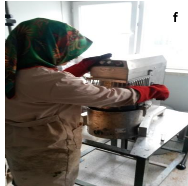
Şekil 3.19 Karışımın tartılması, etüvde ısıtılması ve mikserde homojen olarak karıştırılması.
