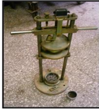
Şekil 3.14 Agregada darbelenme değeri tayini için kullanılan deney cihazı.
