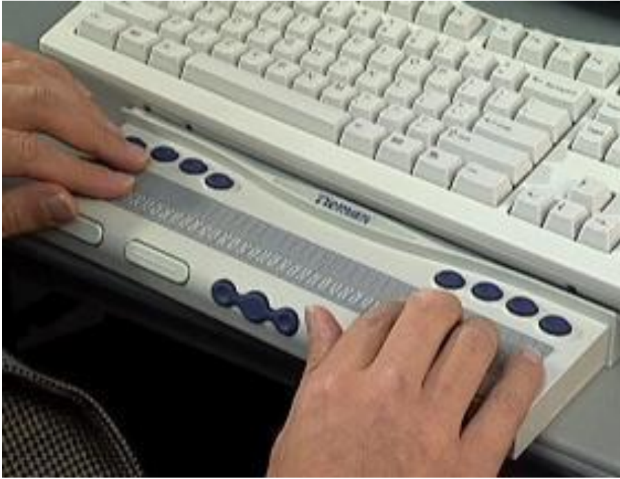
Resim 3.4 Görme engelliler için kabartma ekranlar
