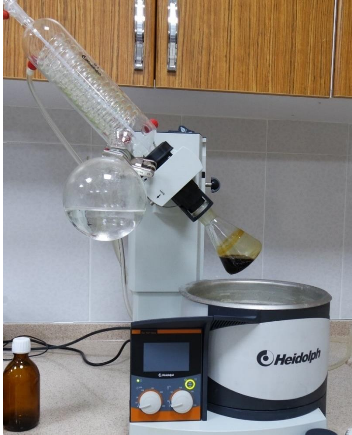
Resim 3.3 Rotary evaparatörde alkolün uçurulması.
