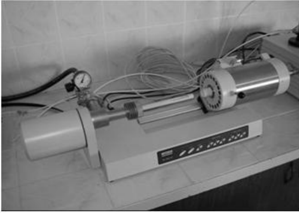
Şekil 3.12. Isıl genleşmenin ölçülmesinde kullanılan dilatometre
