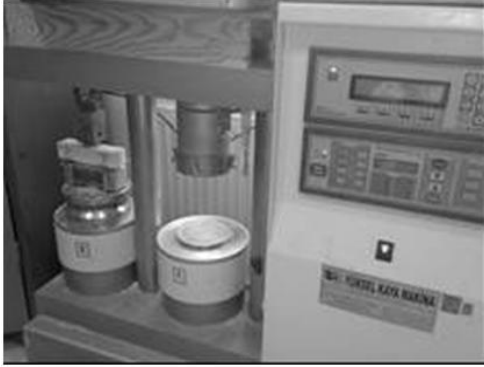
Şekil 3.9. Basınç ve eğilme presi
