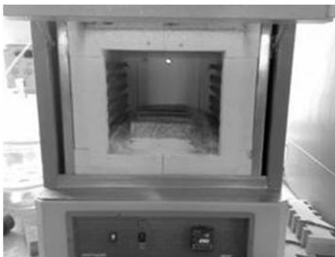
Şekil 3.10. Numunelere yüksek sıcaklığın uygulandığı kül fırını
