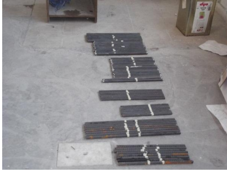
Resim 3.1 Tez çalışmasında kullanılmak üzere hazırlanan donatı numuneleri
