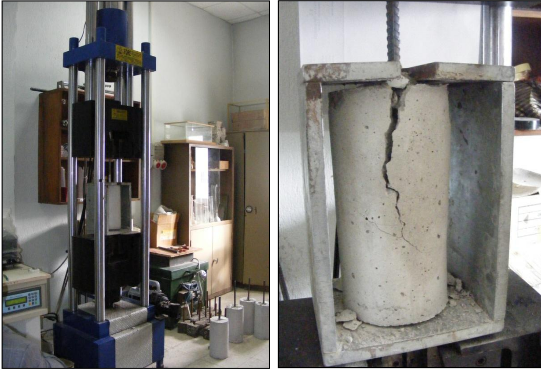
Resim 3.5 ekip-ıkarma deneyi uygulanan silindir numune
