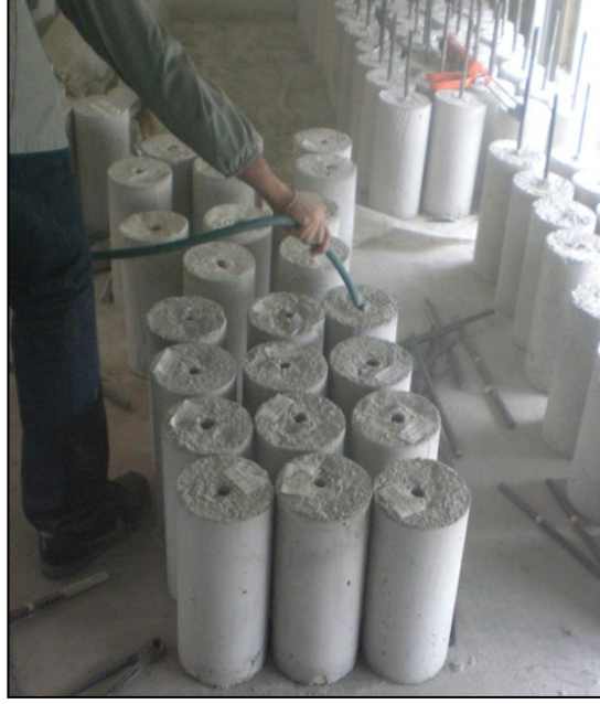
Resim 3.3 Ankraj yerleştirilmek üzere temizlenen silindir numuneler
