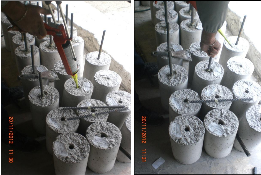
Resim 3.4 Kimyasal yapıştırıcı sıkılan ve nervürlü donatı yerleştirilen silindir numuneler
