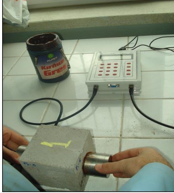
Resim 3.5. Numunelerin ultrases geçiş hızlarının ölçülmesi
