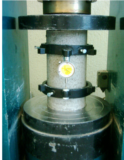
Şekil 3.7 Silindir Numunelerde Yük-Birim Boy Kısalma Ölçümü
