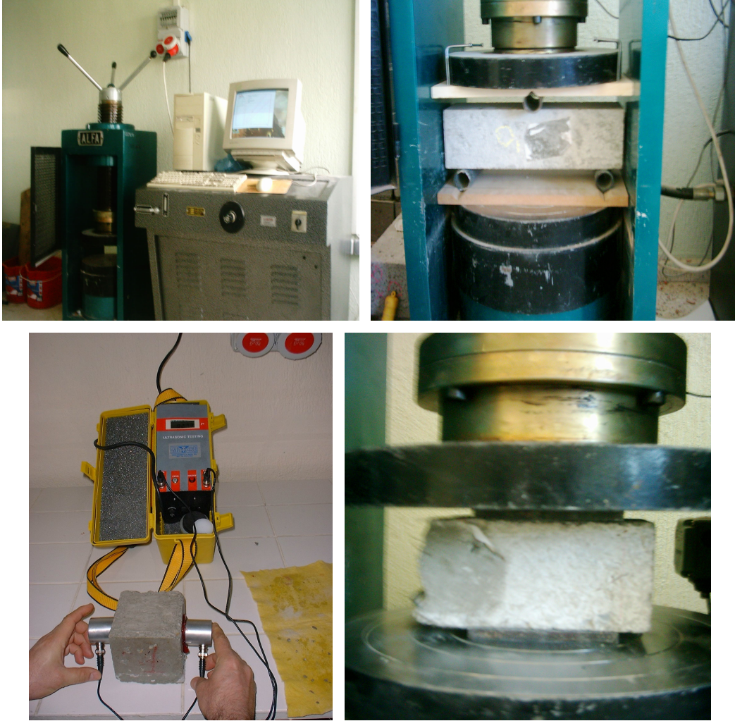
Şekil 3.6 Deneyde Kullanılan Pres ve Ultrases Hızı Ölçüm Cihazı
