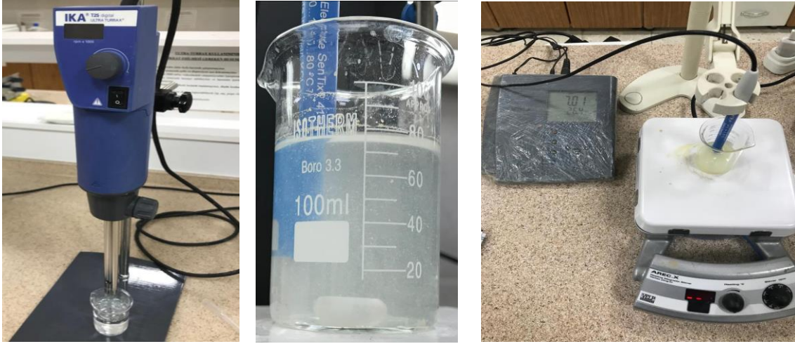
Şekil 3.3 Kopolimer süspansiyon hazırlamasında kullanılan homojenizatör (solda) disperse haldeki kopolimer süspansiyonu (ortada) ve manyetik karıştırıcıda pH-metre ölçümü (sağda).
