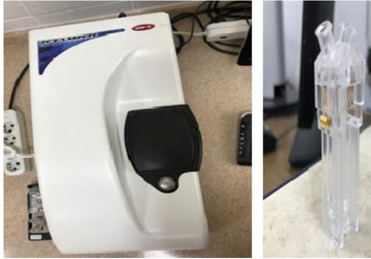
Şekil 3.4 Deneysel olarak kullanılan zeta potansiyel ölçüm cihazı ve ölçüm hücresi.
