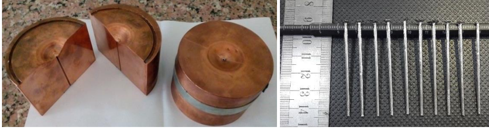
Resim 3.2 Döküm işleminde kullanılan bakır kalıplar ve üretilen amorf \text{Co}_{42}\text{Cu}_1\text{Fe}_{20}\text{Ta}_{5.5}\text{B}_{26.5}\text{Si}_5 alaşım numuneleri.
