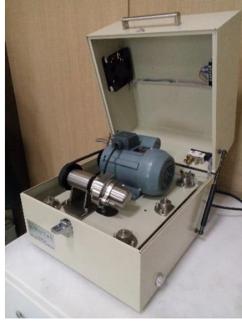
Resim 3.3 Kompozit tozların işlem gördüğü yüksek devirli bilyalı öğütme cihazı.
