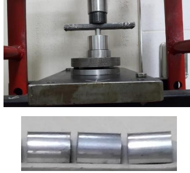
Resim 3.4 Deneyel çalışmalarda kullanılan hidrolik pres, şekillendirme kalıbı ve üretilen numuneler.
