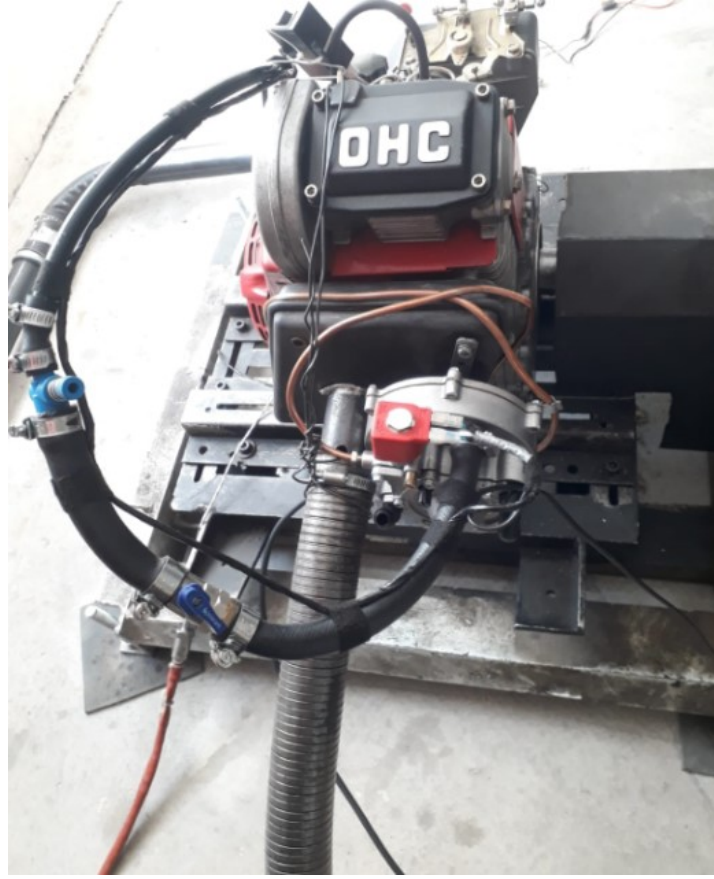
Resim 3.3 Benzin motoruna LPG uygulaması.
