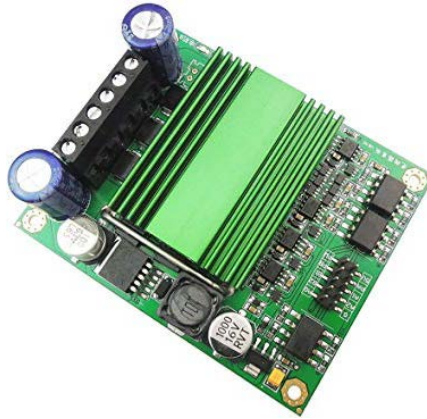
Resim 3.9 Dual DC motor 100A sürücü kartı.
