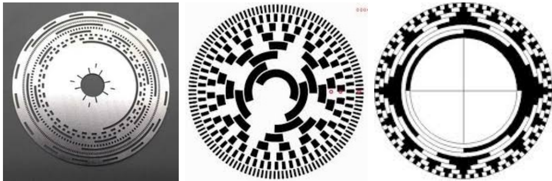
Şekil 3.25 Üç farklı şekilde kodlanmış mutlak enkoder kod diski.
