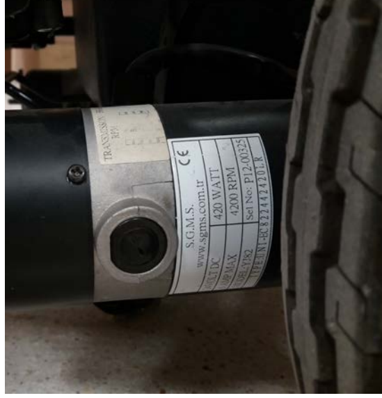
Resim 3.1 Araç üzerinde kullanılan DC elektrik motoru.
