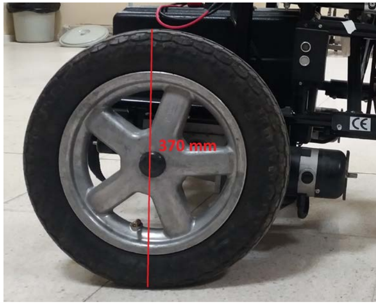
Resim 3.2 Araç üzerinde kullanılan tekerlek.
