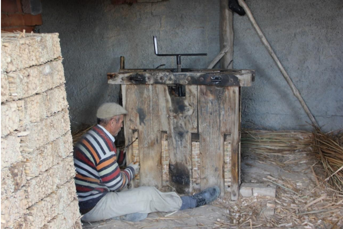
Schoenoplectus lacustris L. 'in atölyede kesilip birleştirilip iple bağlanarak sıkıştırılması-2
