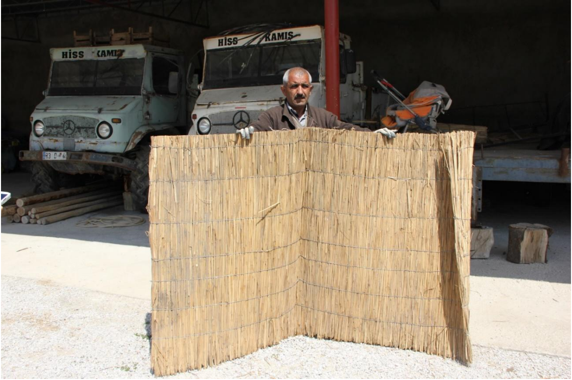
Duvar izalasyonunda kullanılan Phragmites australis L. "Pilate" (köpük manasına gelmektedir.)
