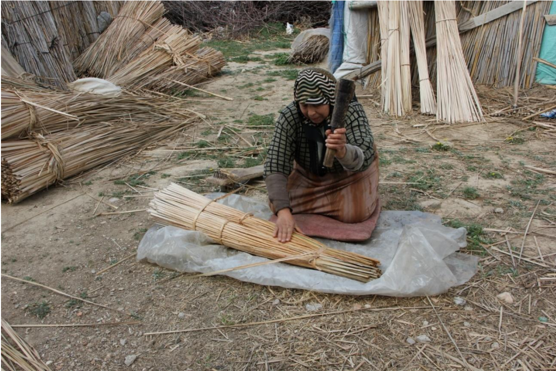
Typha angustifolia L. özünün demirle yumuşatılmak için ezilmesi
