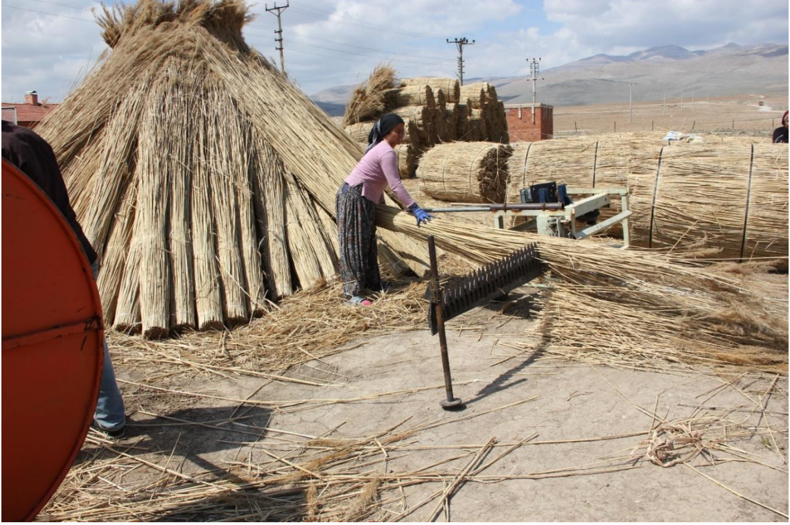
Phragmites australis L. 'in kesme makinasıyla kesilmesi işlemi-1
