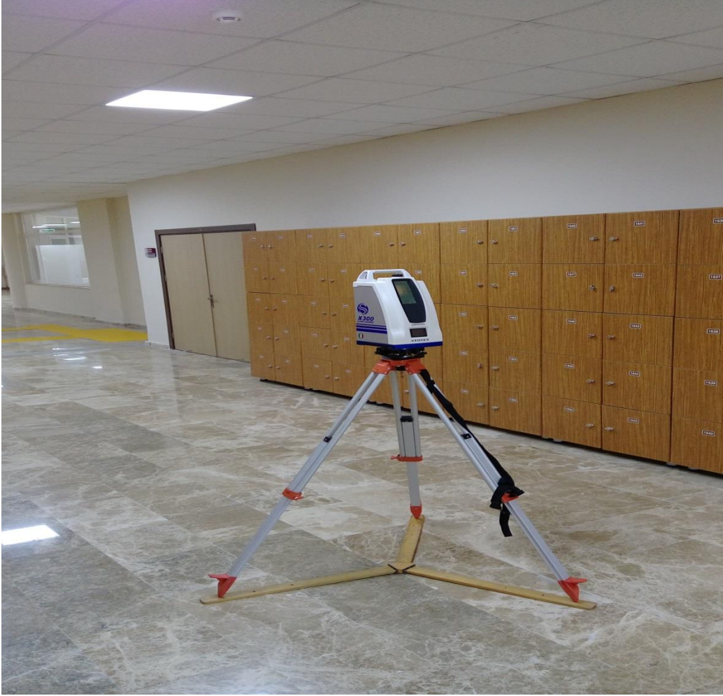
Resim 4.2 Lazer tarama sistemi ile koridorun taranması.
