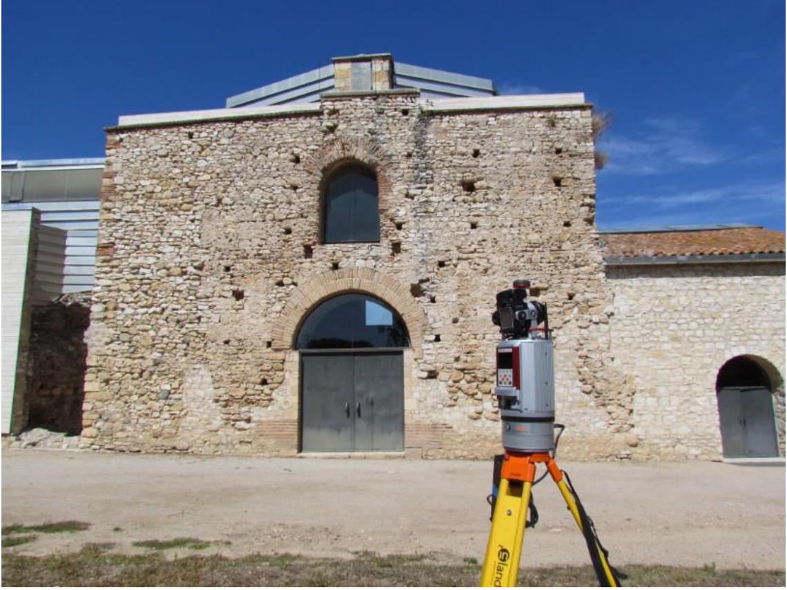
Resim 2.2 Örnek yersel lazer tarama sistemi.
