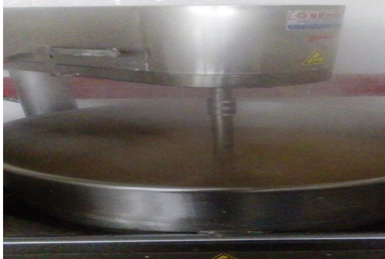
Resim 3.2 Lokum üretim kazanı (Gümüş, Türkiye 100 kg ürün kapasiteli, krom nikel kalite, hidrolik yapıda kolay boşaltma sağlayabilen, çift devirli karıştırıcı ve karıştırma hızı 30-60 D/ D).
