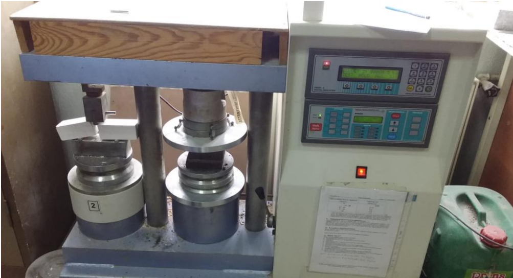
Resim 3.8 Eğilme testi için numune yerleşim şekli.
