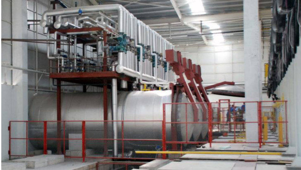
Resim 2.2 Alfa alçısının otoklavda üretimi (İnt.Kyn.8).
