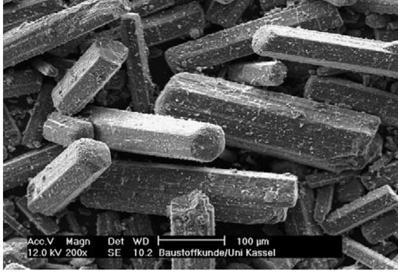
Şekil 2.2 Alfa alçısı SEM görüntüsü (Singh and Middendorf 2007).
