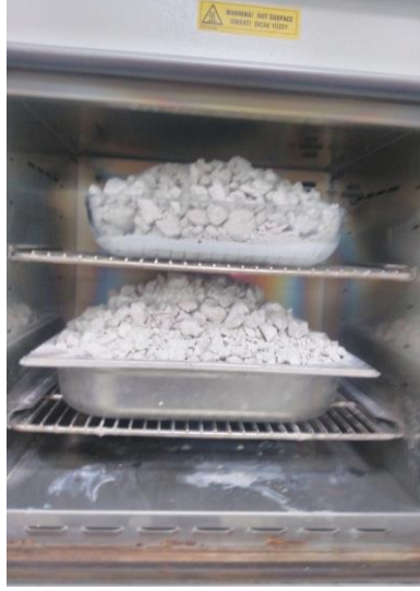
Resim 3.2 Atığın etüv içerisinde kurutulması.
