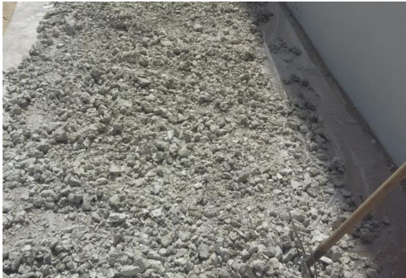
Resim 3.1 Bor işlem atığının kurutulması.
