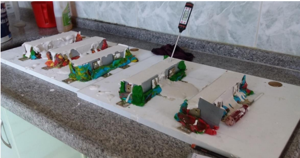
Resim 3.7 Numunenin dijital sıcaklık ölçümü.
