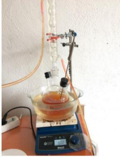
Resim 5.3 Manyetik ısıtıcıda atık kızartma yağının ve metoksetin karıştırılması.
