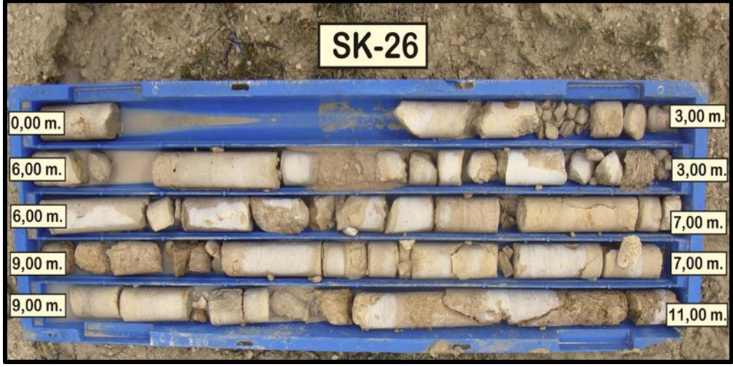
Resim 4.10 Çalışma alanında incelenen 26. sondaj kuyusuna ait karot sandığı.
