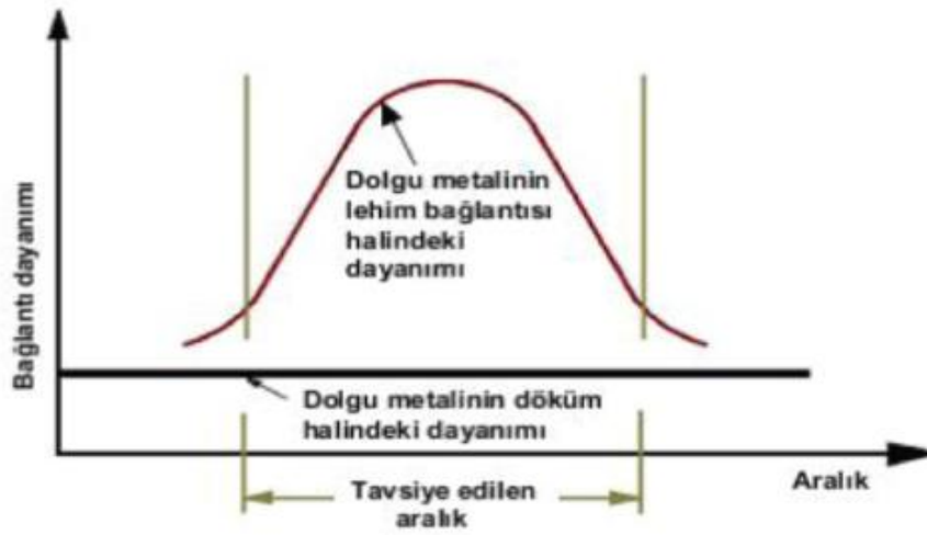
Şekil 2.7 Lehimleme Bölgesinin Mukavemeti Üzerine Lehimleme Aralığının Etkisinin Şematik Gösterilmesi.
