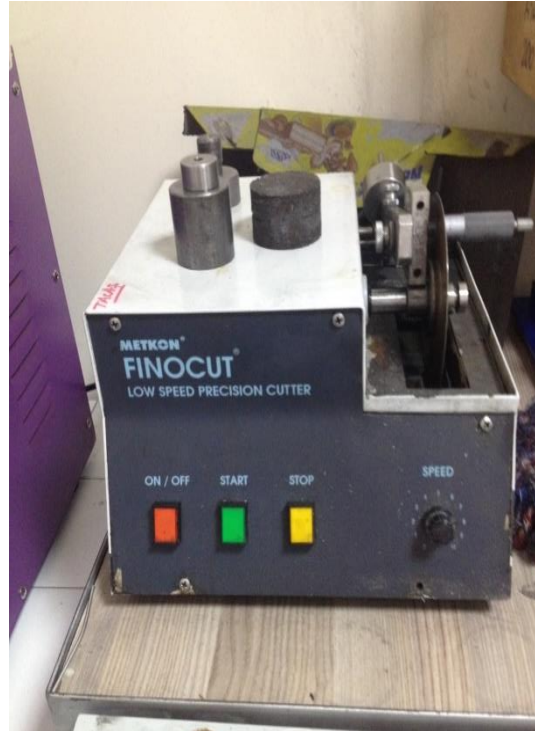
Resim 3.4 Metkon Hassas Kesme Cihazı.
