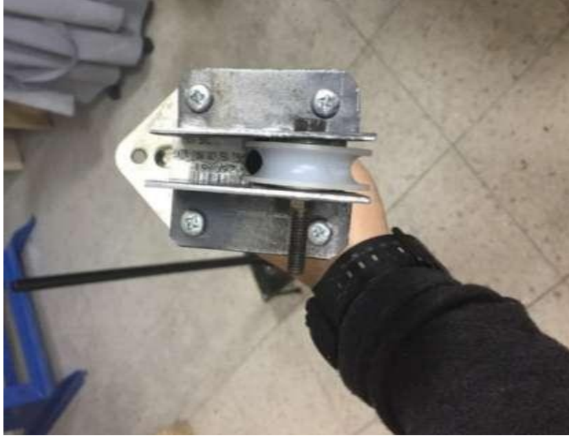
Resim 3.4 Serbest Ağırlık Düşürme Test Cihazının Makara Sistemi.
