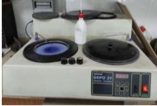
Resim 3.8 Mikro Yapı Analizi İçin Zımparalama İşleminin Yapıldığı GRİPO 2V Cihazı.
