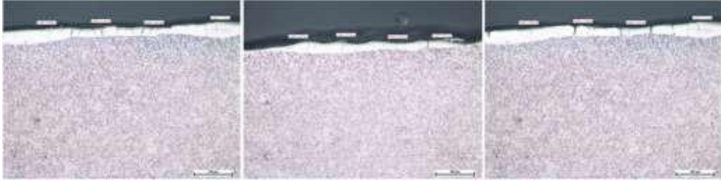
Resim 4.6 Tungsten-Toryum (W-Th) Kaplanan Numuneler, Soldan Sağa, 50V, 100V ve 150V, 900Hz 100x Tabaka Mikroyapısı.
