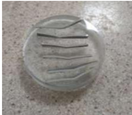
Resim 3.7 Numunelerin Soğuk Kalıplanmış Hali.
