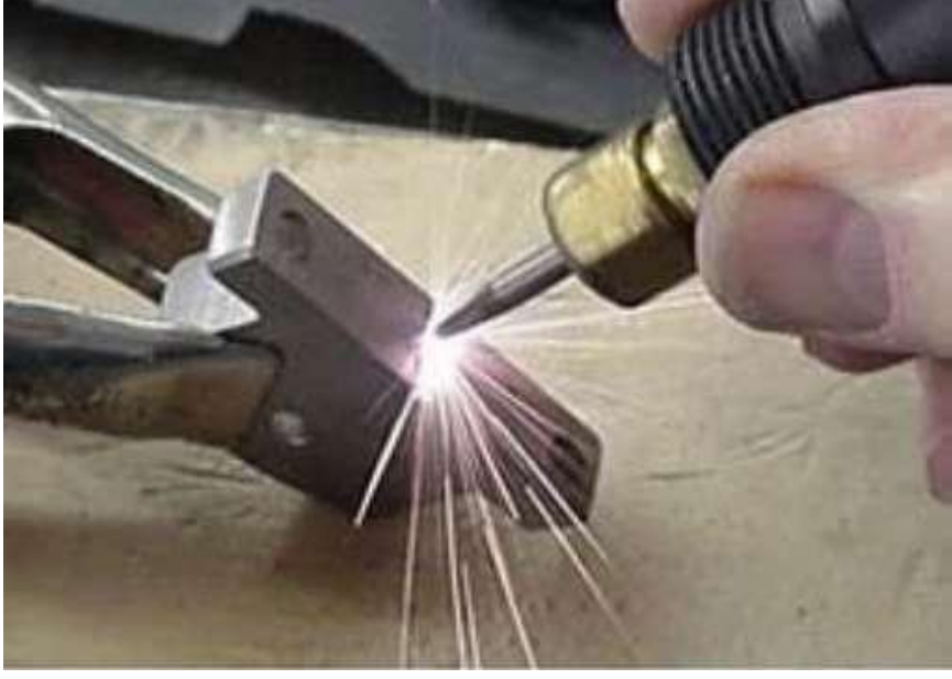
Resim 2.1 Elektro Kıvılcım Yöntemi (ESD) ile onarım yapılabilir.
