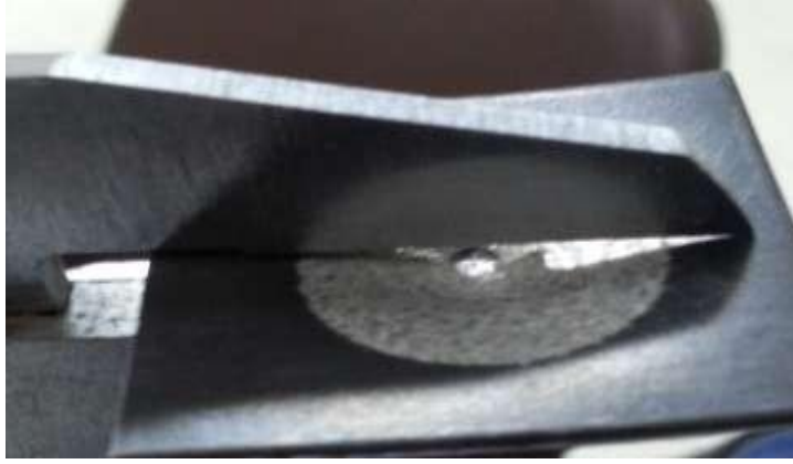
Resim 4.19 M42 Çeliği Deformasyon İz Yüksekliğinin Ölçümü.
