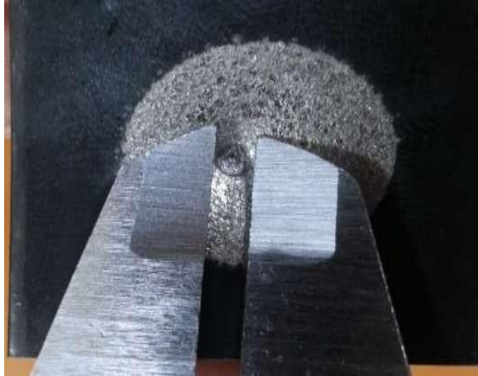
Resim 4.18 M42 Çeliği Üzerine Yapılan Bir Kaplamanın Deformasyon İndent Genişliğinin Ölçülmesi.
