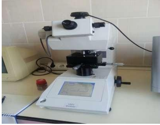
Resim 3.2 Numunelerin Sertliklerinin Ölçüldüğü Mikro Sertlik Cihazı, Shimadzu HMV2.
