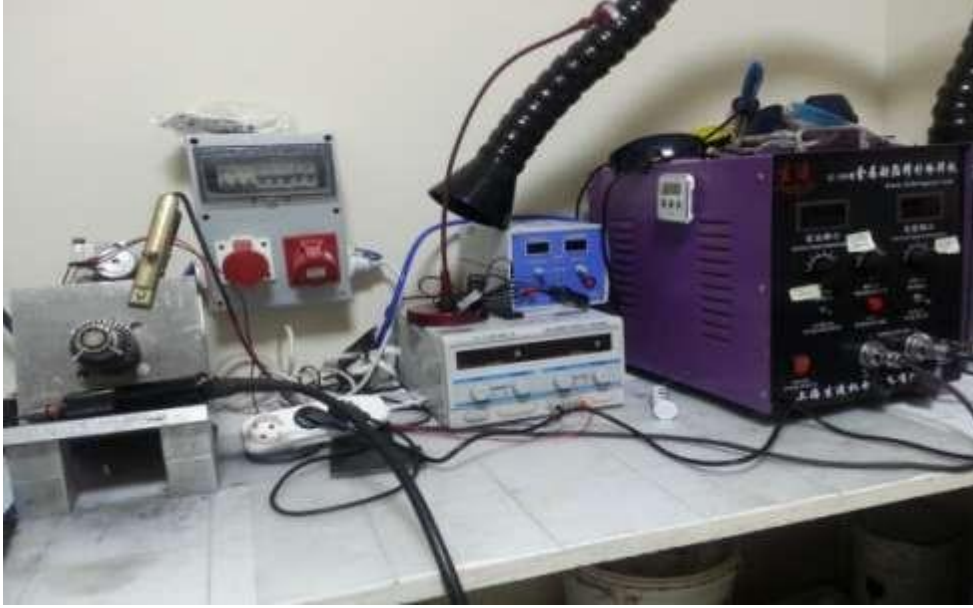
Resim 3.1 Kullanılan Deney Düzeneği ve Elektro Kıvılcım Biriktirme Cihazı (ESD).
