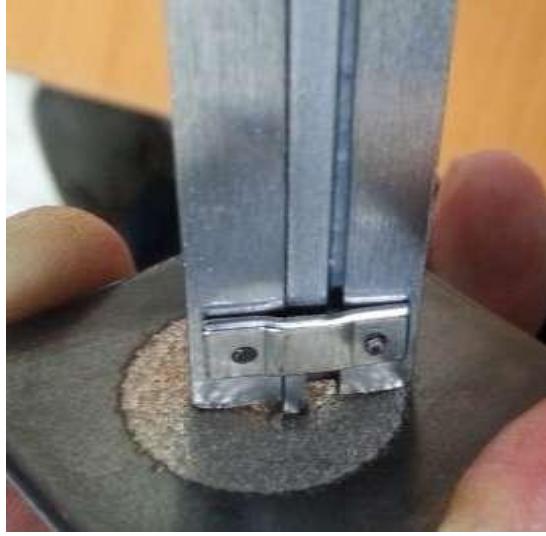
Resim 4.20 M42 Çeliği Deformasyon İndent Derinliğinin Ölçümü.
