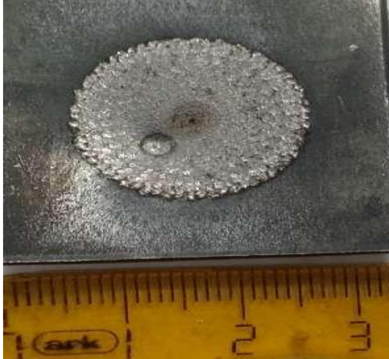
Resim 4.16 W Kaplanmış M42 Çeliği Üzerindeki Deformasyon İzi.
