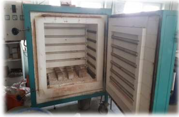
Resim 3.7 Yüksek sıcaklık deneyinde kullanılan fırın.
