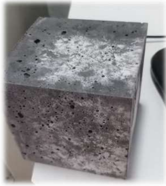
Resim 4.1 Çiçeklenme meydana gelen geopolimer örnekleri.
