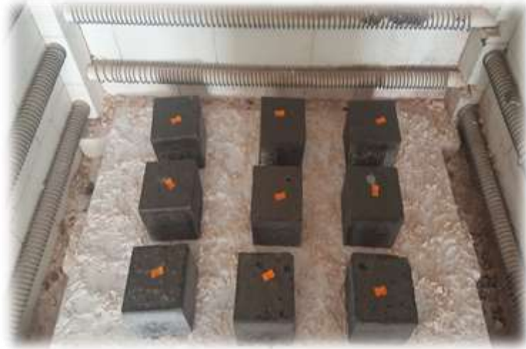
Resim 3.8 Yüksek sıcaklığa maruz bırakılan geopolimer beton numunelerinin ilk halleri.
