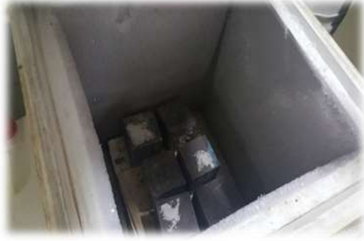
Resim 3.6 Donma-çözülme deneyi için -20 °C'ye kadar soğuma yapabilen donduruculara konulan Geopolimer beton numuneleri.
