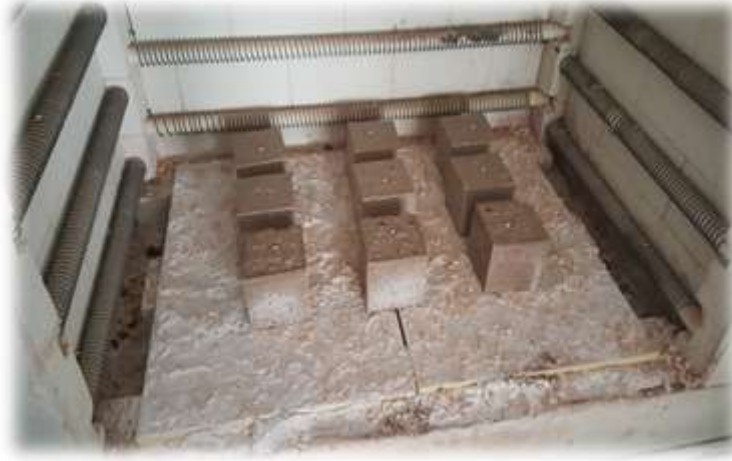
Resim 3.9 Yüksek sıcaklığa maruz bırakılan geopolimer beton numunelerinin son halleri.
