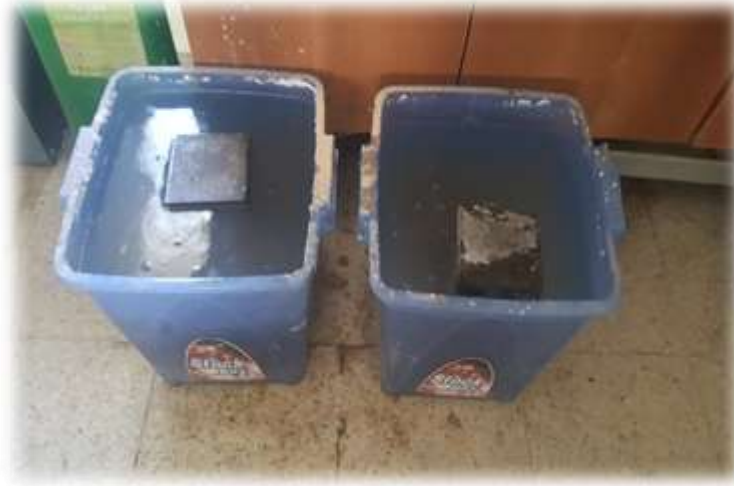
Resim 3.10 MgSO_4 ve NaSO_4 etkisine maruz bırakılan numuneler (sağdaki MgSO_4 ve soldaki NaSO_4 ).
