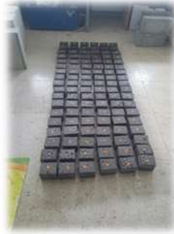
Resim 3.4 Etüv kürü uygulanmış geopolimer betonlar.
