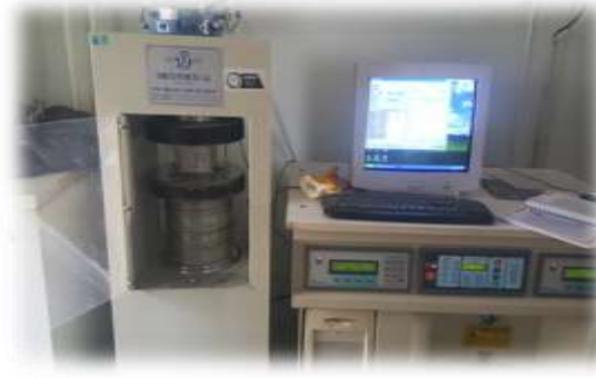
Resim 3.5 Çalışmada kullanılan beton presi.
