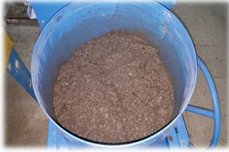
Resim 3.2 Geopolimer beton hazırlamada kullanılan mikser ve taze geopolimer beton karışımı.
